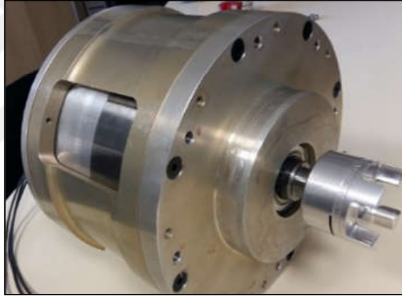
Şekil 3.1. 9-Fazlı prototip AS-SMSM motor
