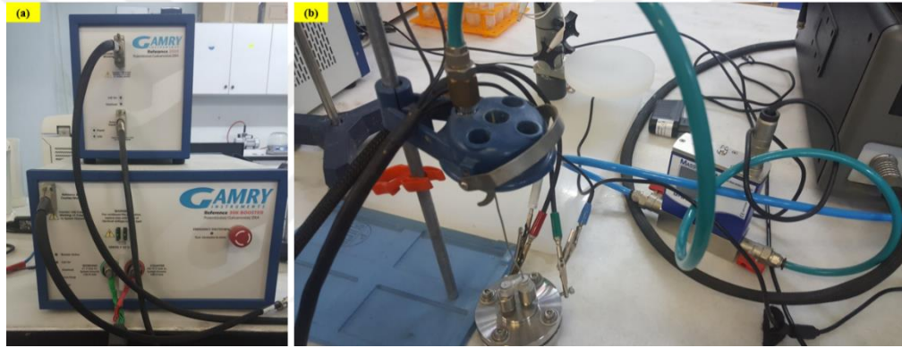
Şekil 4.15. (a) Şarj/deşarj deneylerinde kullanılan Gamry Reference 3000 Potentiostat/Galvanostat/ZRA cihazı, (b) hava pil hücresi ve deney düzeneği.
