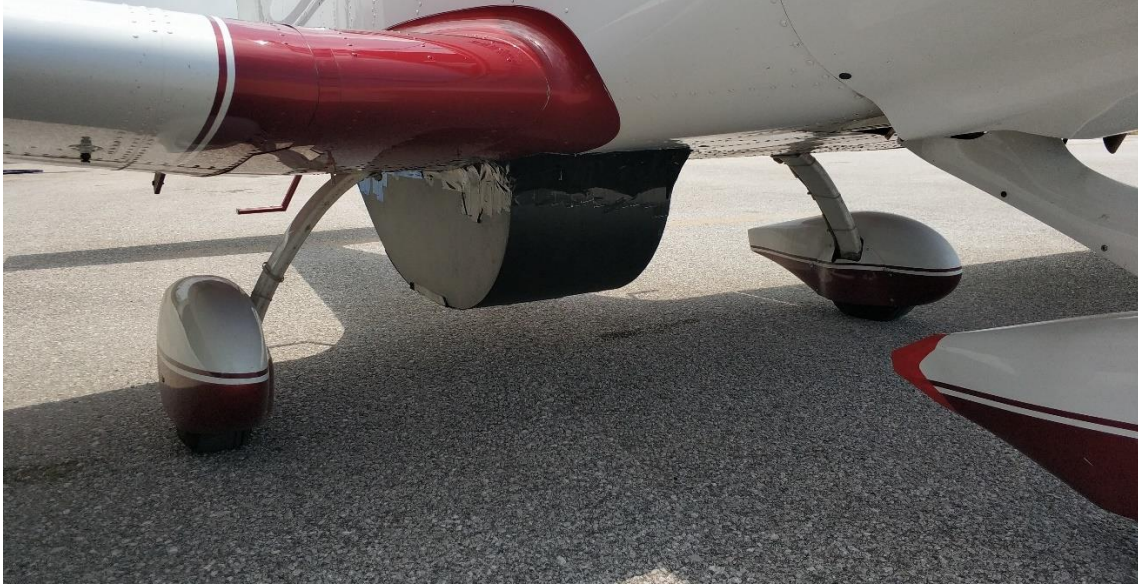
Resim 4.5 Kamera Sistemi Uçak Bağlantısı.
