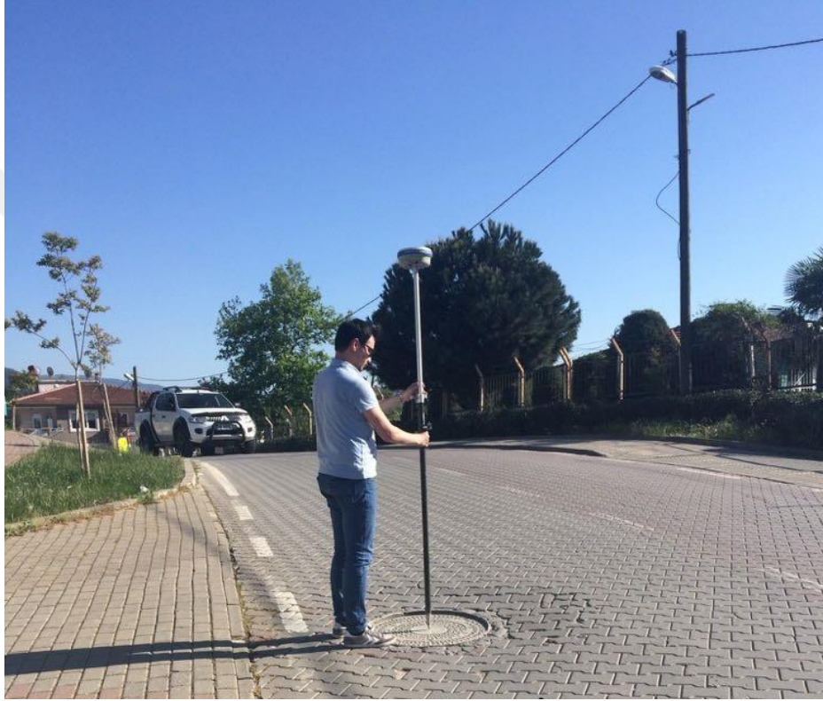
Resim 4.8 Yer Kontrol Noktası Ölçümü.
