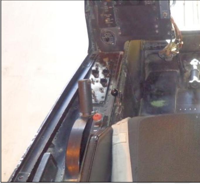
Resim 3.3. Modifikasyon yapılan kokpit yan paneli
