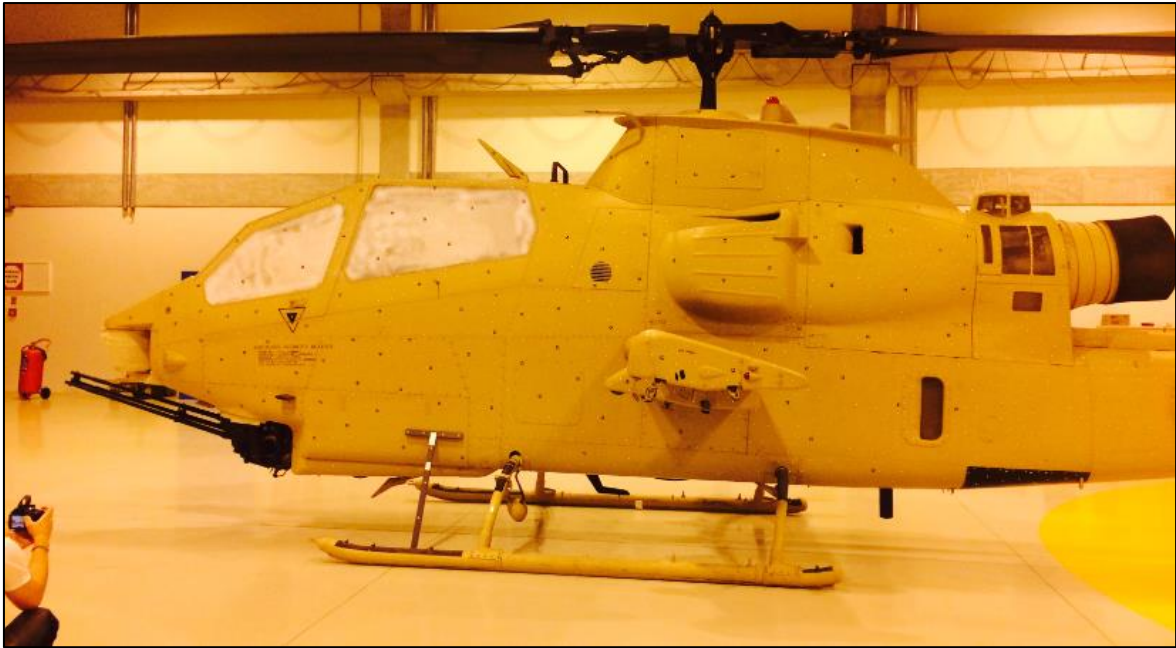
Resim 2.2. Yapısal ışık tarama yöntemi ile hava aracı gövdesinin taranması
