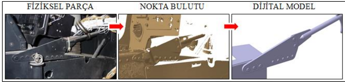
Şekil 2.1. TM ile fiziksel modelden dijital modele geçiş süreci
