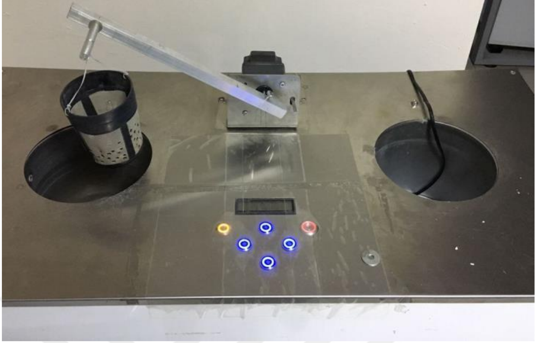
Resim 9: Çalışmada kullanılan termal döngü cihazı.
