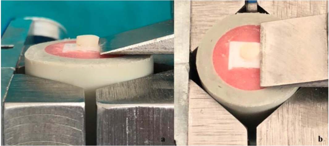
Resim 11: Örneklerin test cihazına sabitlenmesi (a,b).
