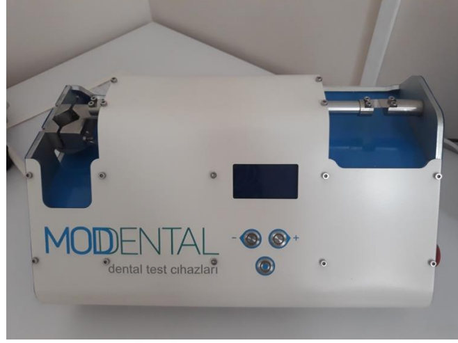
Resim 10: Çalışmada kullanılan makaslama bağlanma test cihazı.
