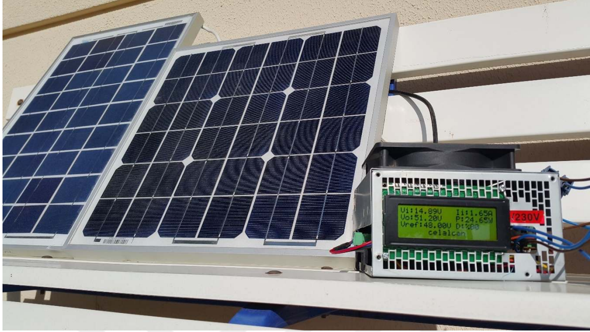
Resim 4.10. Devreler test edilirken akım gerilim ve güç değerleri
