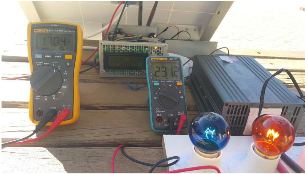
Resim 4.13. 60W’lık panel ile gerçekleştirilen test görseli
