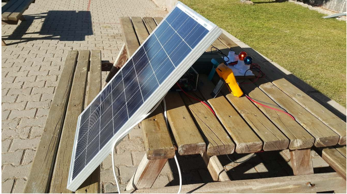
Resim 4.12. Testte kullanılan 60W’lık panel
