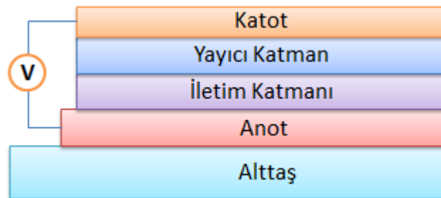
Şekil 2.9. OLED yapısı ve gösterimi.
