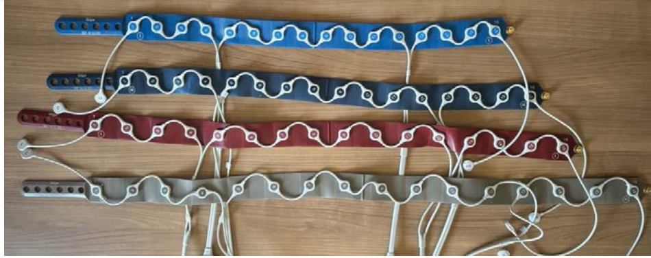
Şekil 3. Elektriksel Empedans Tomografisi Elektrot Kemerleri
