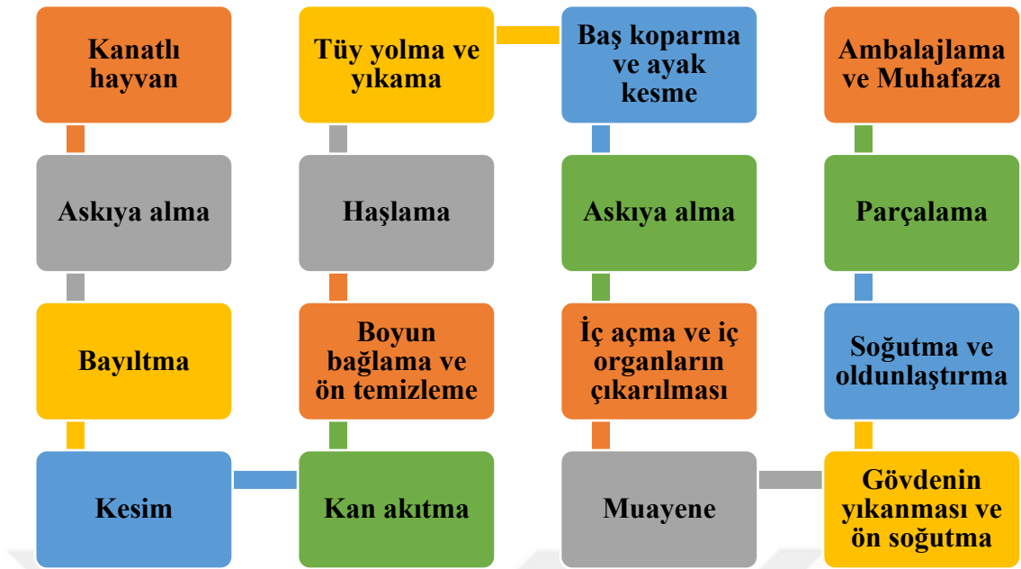
Şekil 1.2. Kanatlı eti üretim akış şeması (Arslan 2020).
