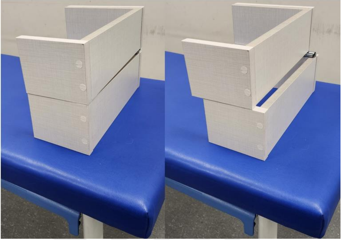
Şekil 11: Lateral dekübit pozisyonda fark ölçümü için tasarladığımız platform
