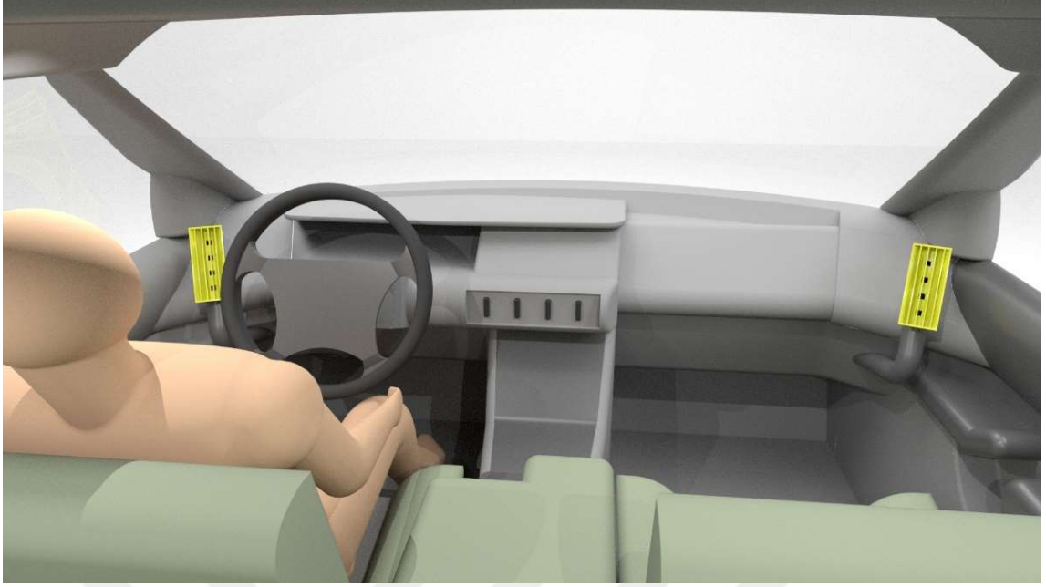
Şekil 2.17. Menfez Konum 1 sayısal analiz içerisindeki görseli
