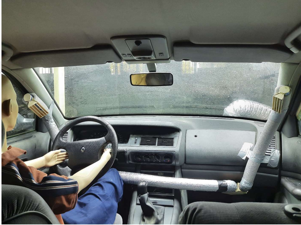
Şekil 2.12. Klima menfez - Konum 3 yerleşiminin araç içi görünümü
