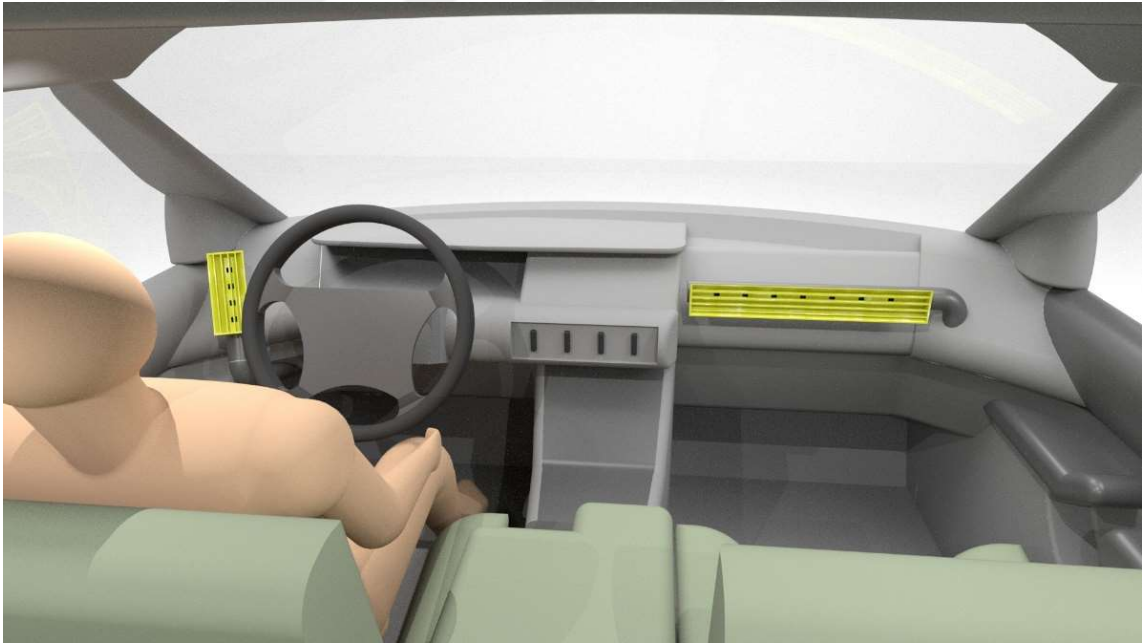
Şekil 2.18. Menfez Konum 2 sayısal analiz içerisindeki görseli
