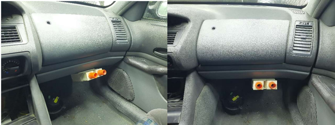
Şekil 2.3. Kabin içerisinde ahşap hava kanalının görüntüsü
