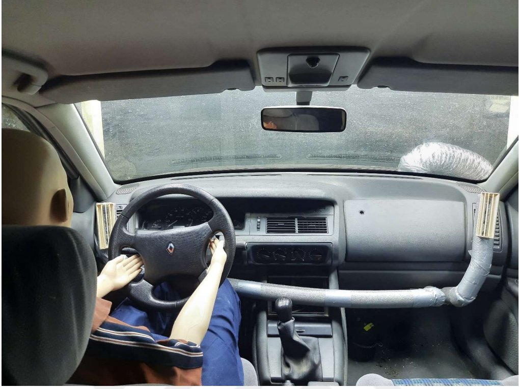
Şekil 2.10. Klima menfez - Konum 1 yerleşiminin araç içi görünümü
