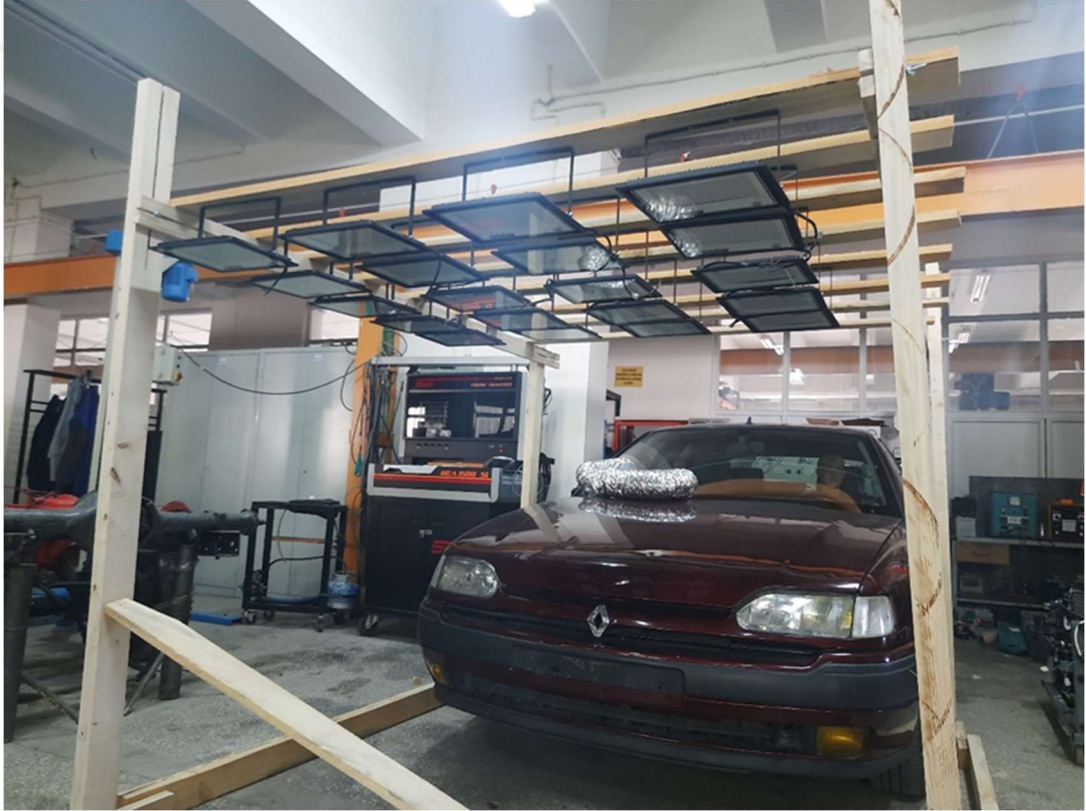
Şekil 2.8. Yapay ışınım standı LED projektör dizilim aşaması
