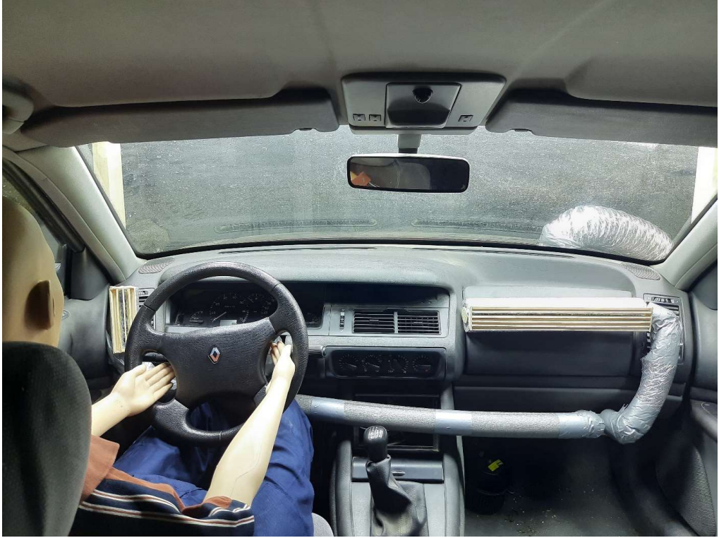
Şekil 2.11. Klima menfez - Konum 2 yerleşiminin araç içi görünümü
