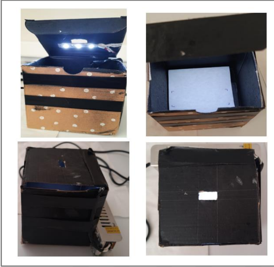
Şekil 2. 9. Elde edilen sonuçların yorumlanması amacıyla fotoğrafların çekilmesi için yapılan ev yapımı kutu.
