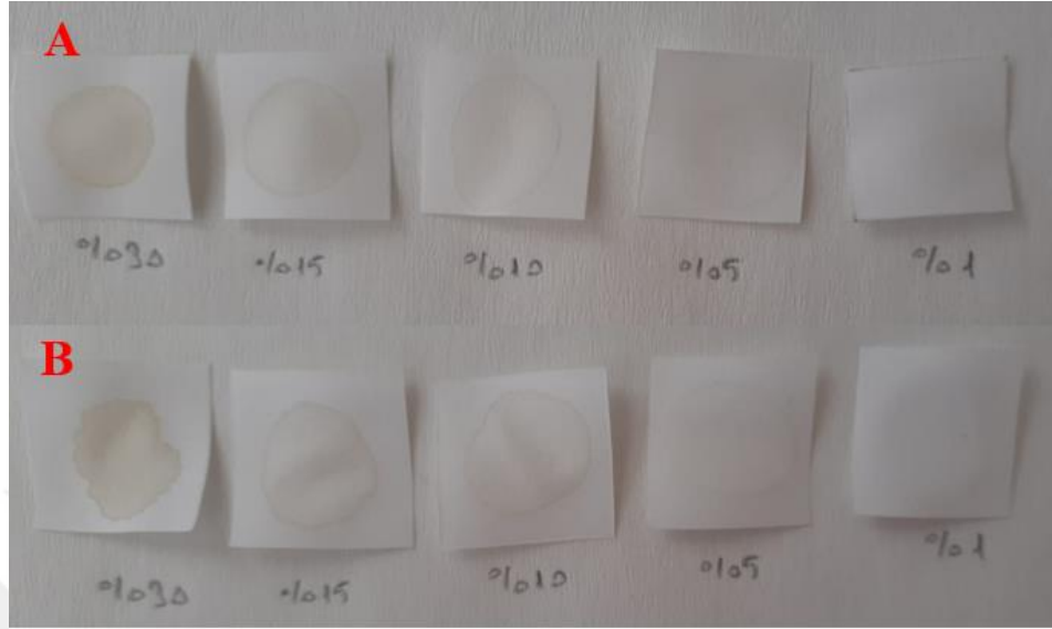
Şekil 3. 23. Whatman kâğıt türü optimizasyonu (A) Grade 41 için (B) Grade 1 için sonuçlar.
