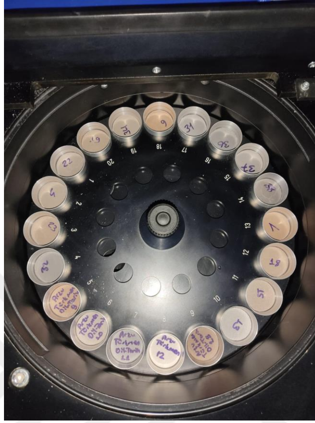
Resim 8. XRF cihazındaki pelet haline getirilmiş örnekler
