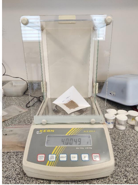
Resim 7. Toz haline getirilmiş örneklerin hassas terazide ölçümü
