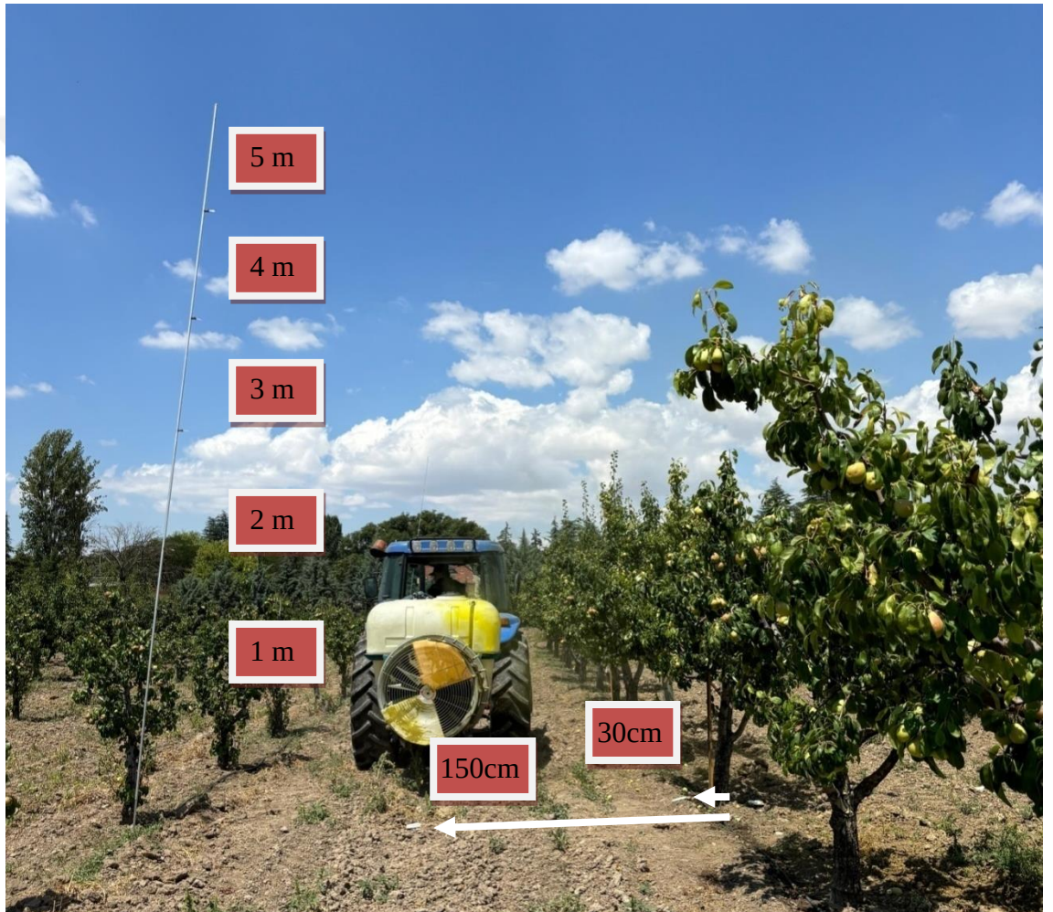
řekil 3.11 Topraęa ve havaya olan ila kayıplarının belirlenmesinde kullanılan rnekleme yntemi
