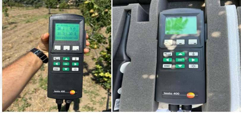
Şekil 3.7 Pülverizatör hava hızı ve meteorolojik verilerin ölçülmesinde kullanılan TESTO 400 cihazı
