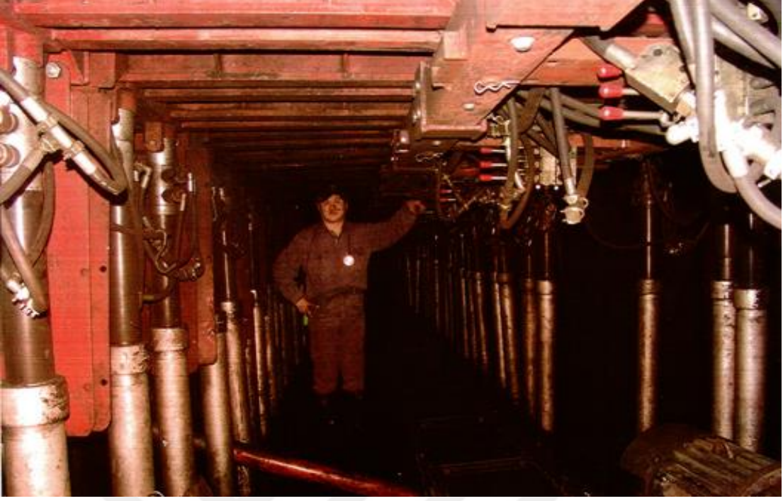
Şekil 6. Kirişli Yarı mekanize tahkimat sistemi ayak içi görünümü (TTK, 2022)
