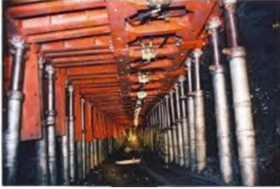
Şekil 4. Çin tipi yarı mekanize olarak anılan yarı mekanize tahkimat sistemi (Çetinkaya, 2019)
