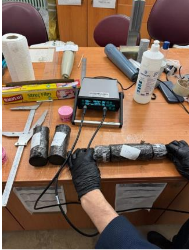
Şekil 15. Ultrasonik dalga hızı testi yapılışı
