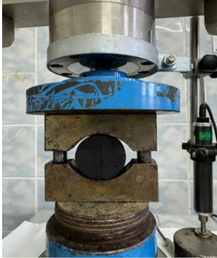
Şekil 17. Endirekt çekme dayanımı deneyi
