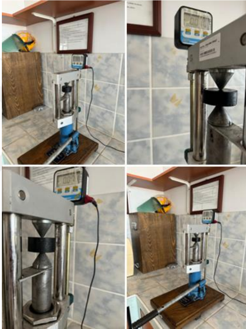
Şekil 18. Nokta yükü dayanımı indeksi deneyi yapılışı
