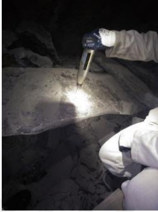
Şekil 10. Yeraltında kayaç bloğuna Schmidt çekici uygulaması
