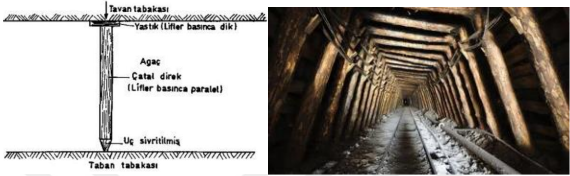
Şekil 2. Ağaç tahkimat uygulaması (Ahıska ve Esen, 1987)
