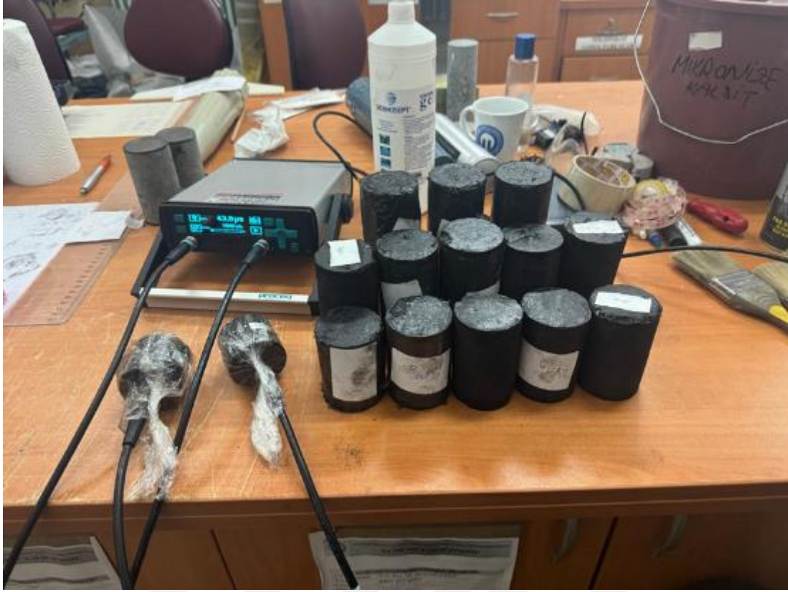
Şekil 19. 1.5, 2 ve 2.5 L/D oranlarında hazırlanan kömür örnekleri
