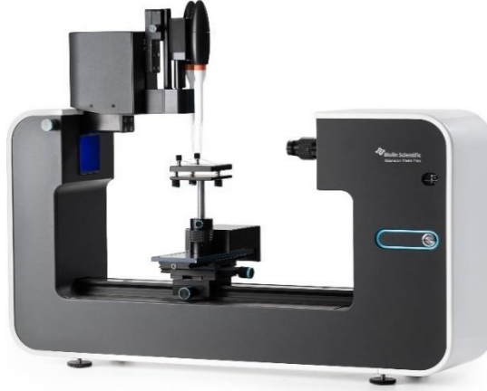
Şekil 2.1 Temas açısı gonyometresi
