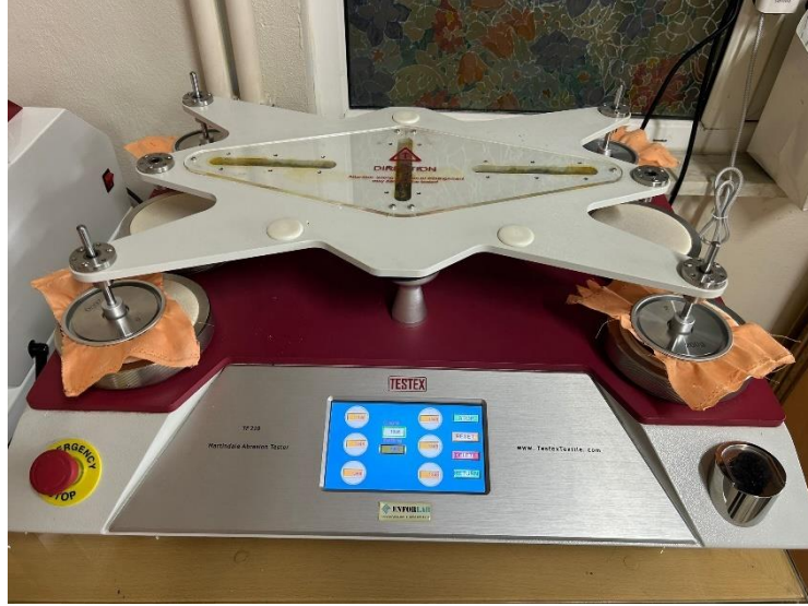
Şekil 3.7 Martindale TF 210 aşınma test cihazı (260 g & 2000 döngü)
