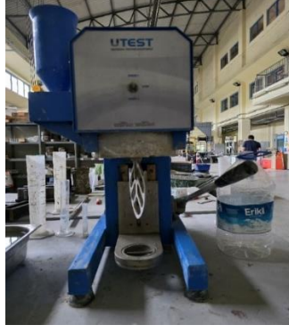
Şekil 5.3 Harç üretimlerinde kullanılan pan tipi mikser
