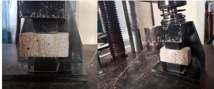
Şekil 5.15 Kırık prizma numuneler ile tek eksenli basınç deneyi
