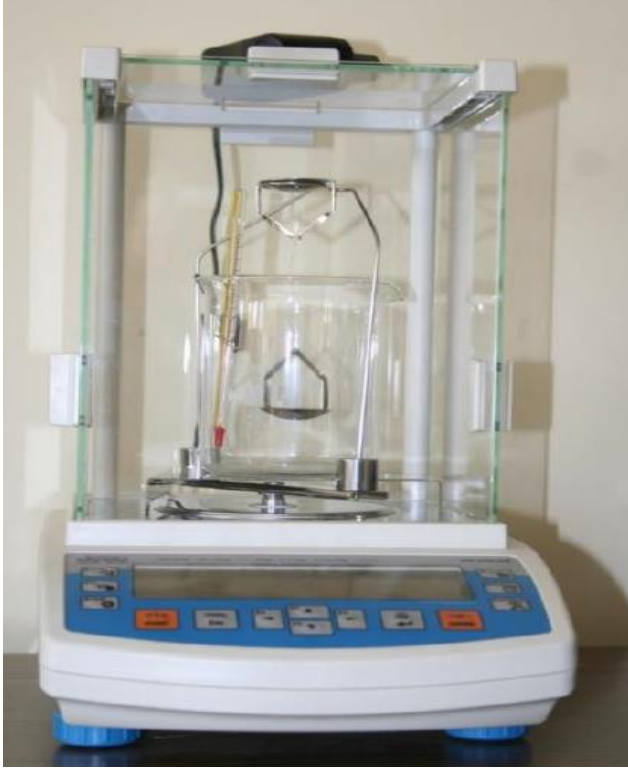
Şekil 3.4 Arşimet deney düzeneği
