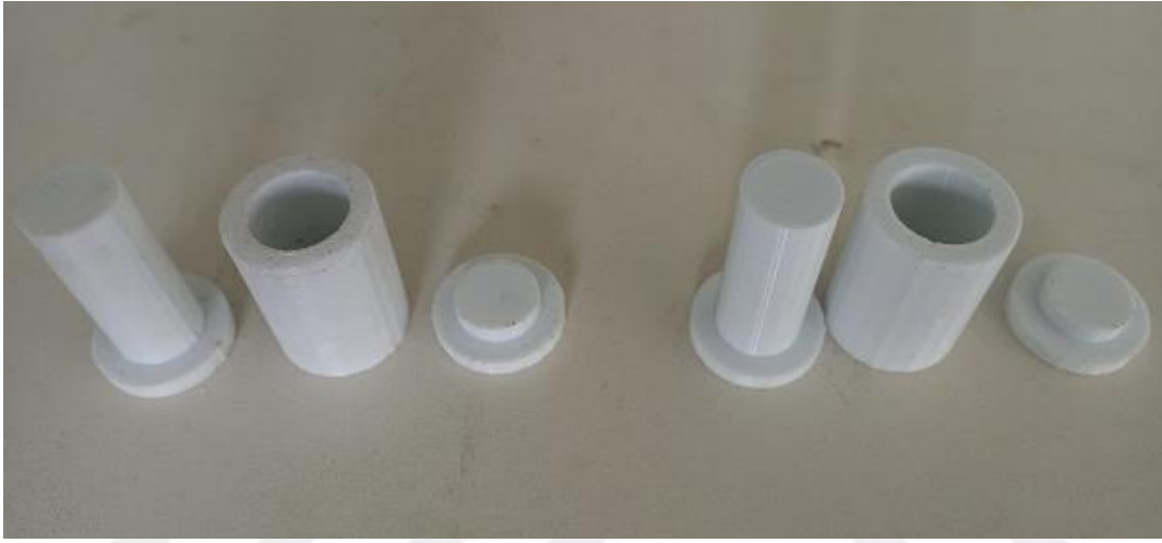
řekil 3.1 3D yazıcı ile retilen PLA kalıplar
