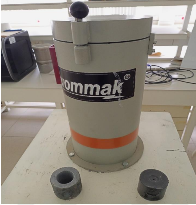
Şekil 3.5 Sodyum iyodür (NaI(Tl)) detektörü dıştan görünümü
