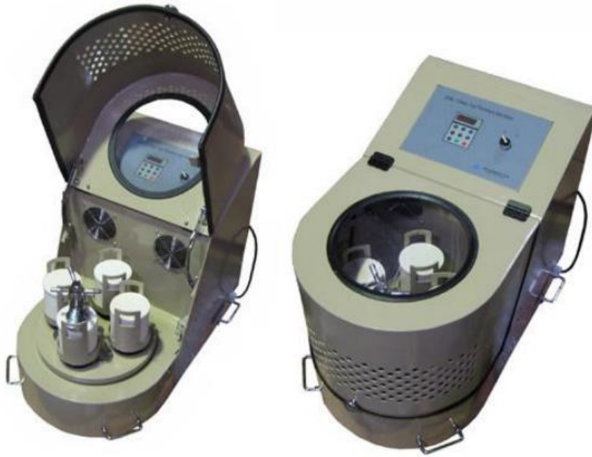
Şekil 3.2. Planetary tipi bilyeli öğütücü değirmen [22].
