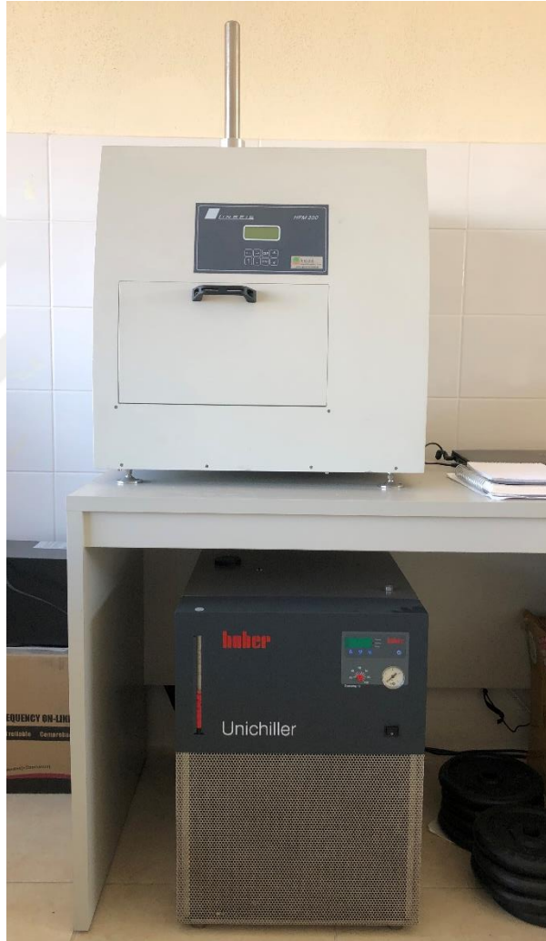
Şekil 2.5. Isı akış ölçer cihazı
