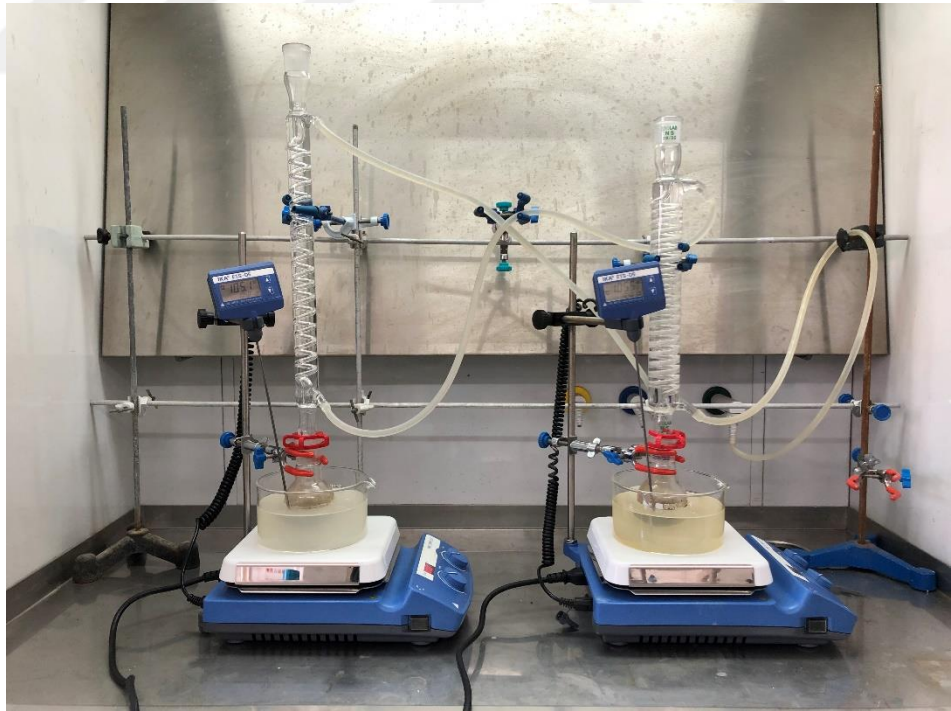
Şekil 2.2. Hemiselüloz tayininde NaOH ile muamele reaksiyonuna ait görsel
