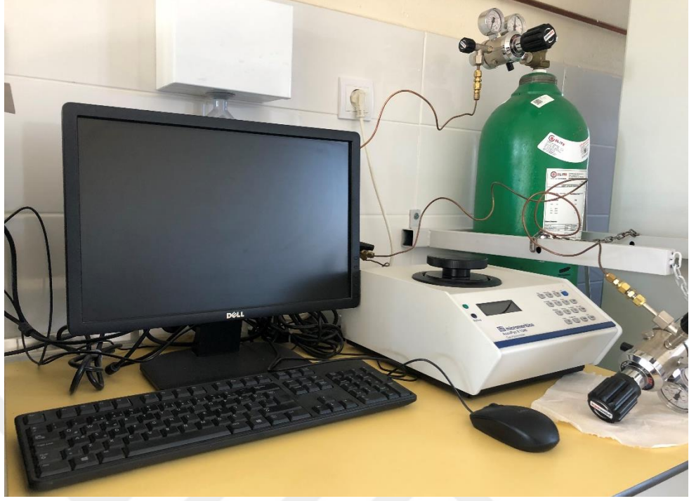
Şekil 2.7. Gaz piknometresi görseli
