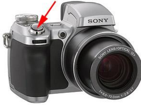
Görsel 2.10. Deklanşör (Kaynak: https://www.britannica.com/technology/shutter-photography )
