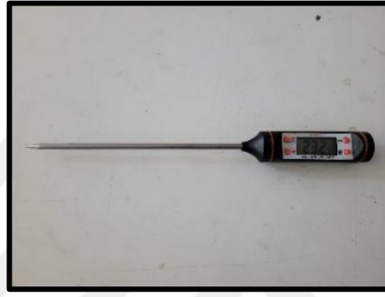
Şekil 3.24. Taze harç ölçüm cihazı
