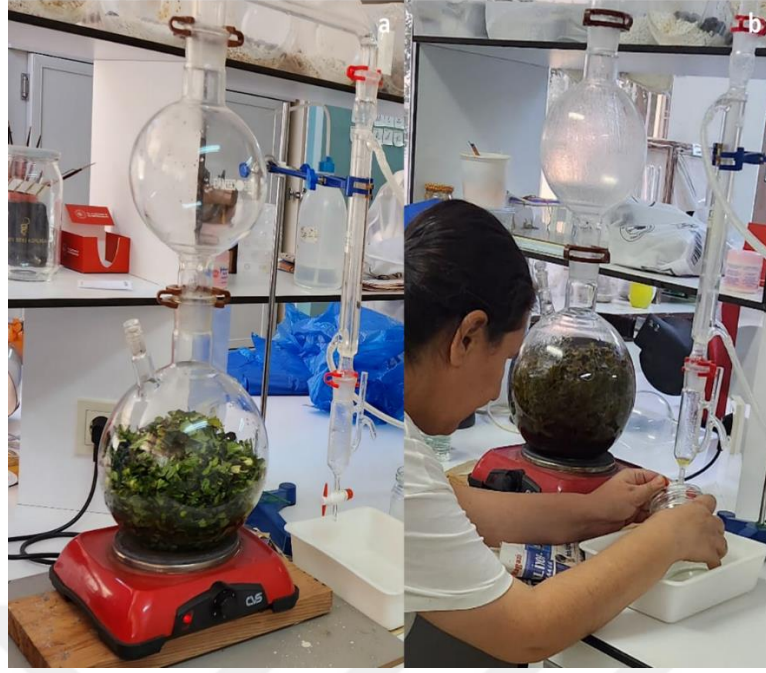
Şekil 3.6. Ceratitis capitata erginleri üzerinde denemelerde kullanılacak uçucu yağların distilasyon işlemi (a) distilasyon işlemi başlangıcında cam fanus içerisine yerleştirilmiş bitki materyali (b) distilasyon işlemi sırasında biriken yağın su kısmından ayrıştırılması
