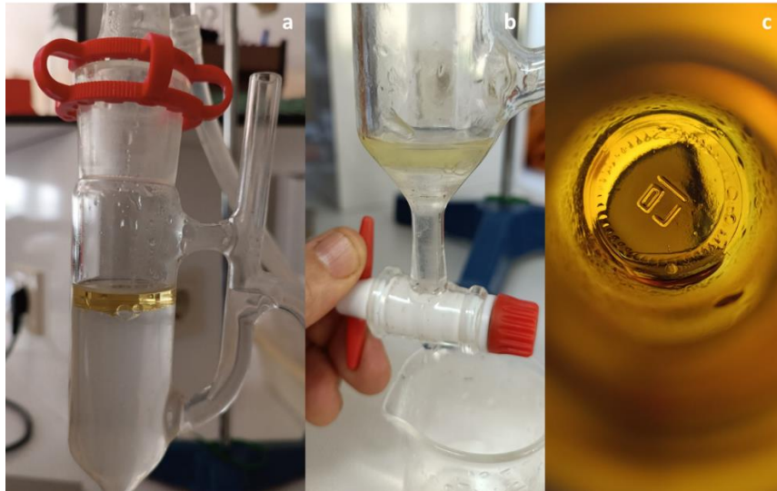
Şekil 3.7. Su distilasyonu ile elde edilen uçucu yağlar (a) su tabakası üzerinde biriken okaliptüs uçucu yağı, (b) su tabakası üzerinde biriken fesleğen uçucu yağı, (c) amber renkli teflon şişe içinde civanperçemi uçucu yağı
