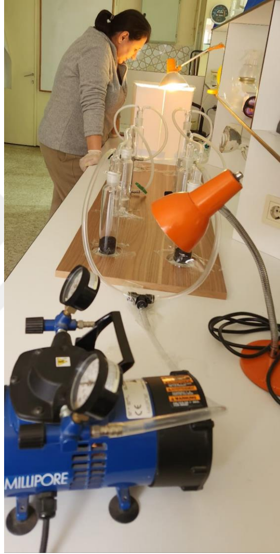
Şekil 3.10. Y-tüp olfaktometre düzeneğinin kurulması
