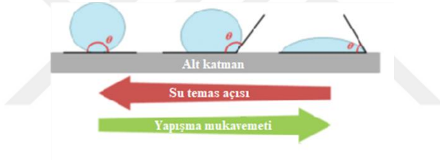
Şekil 4.8 Temas açısının yapışma kuvveti üzerine etkisini gösteren diagram
