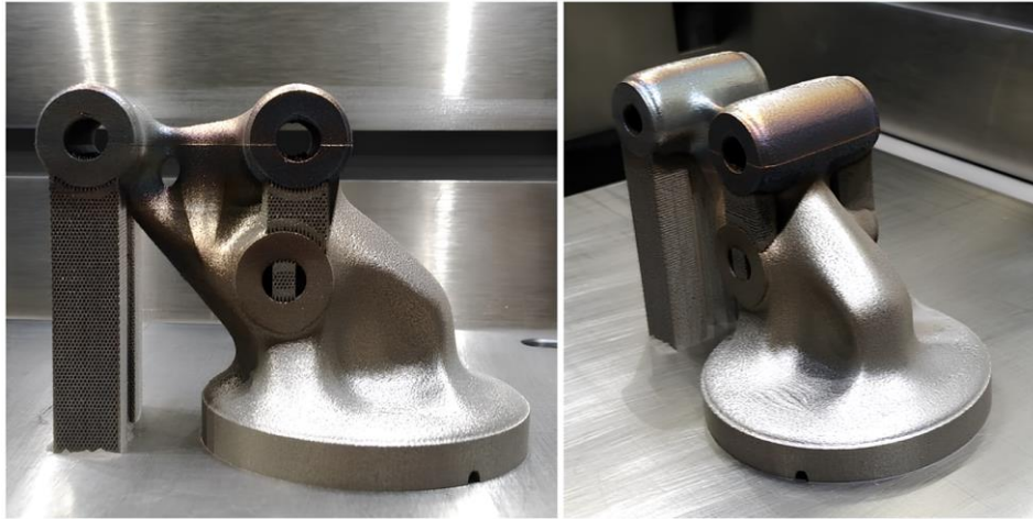
Şekil 4.26 Optimize gergi braketinin üretimi
