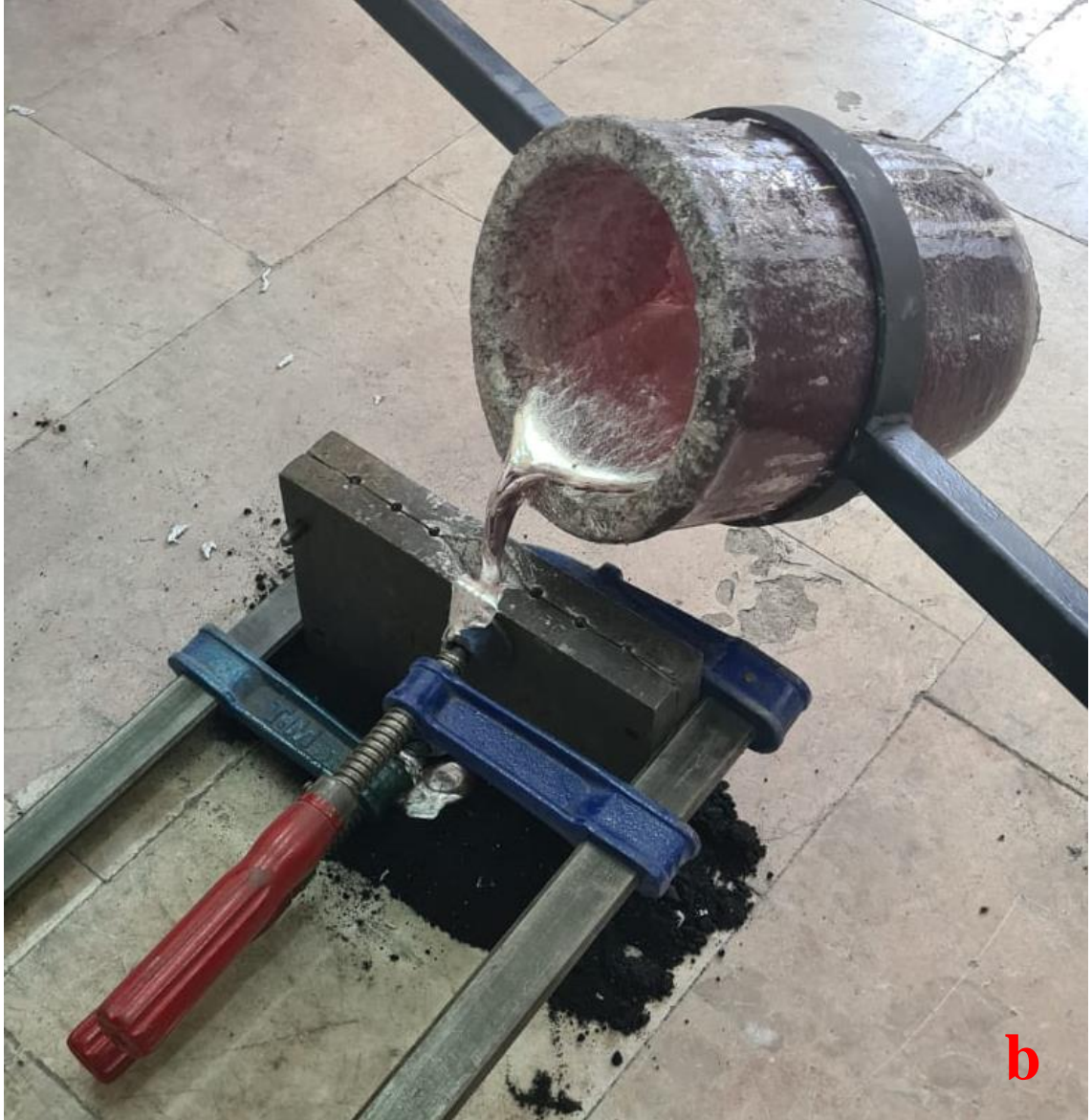
Şekil 7: a) Döküm Öncesi Kokil Kalıplar, b) Döküm Esnasında Alınan Görüntü
