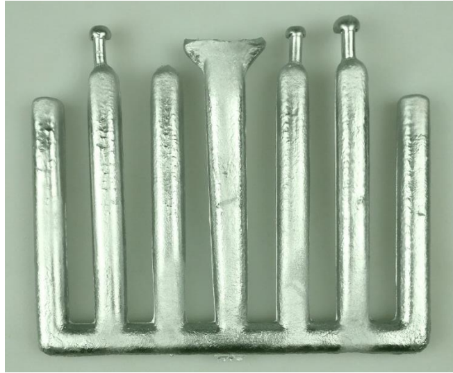
Şekil 24: Mekanik Test Kalıbı Döküm Numune Görüntüsü
