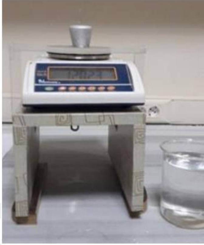
Şekil 9: Arşimet Prensibine Göre Yoğunluk Ölçümü Yapılan Hassas Terazi
