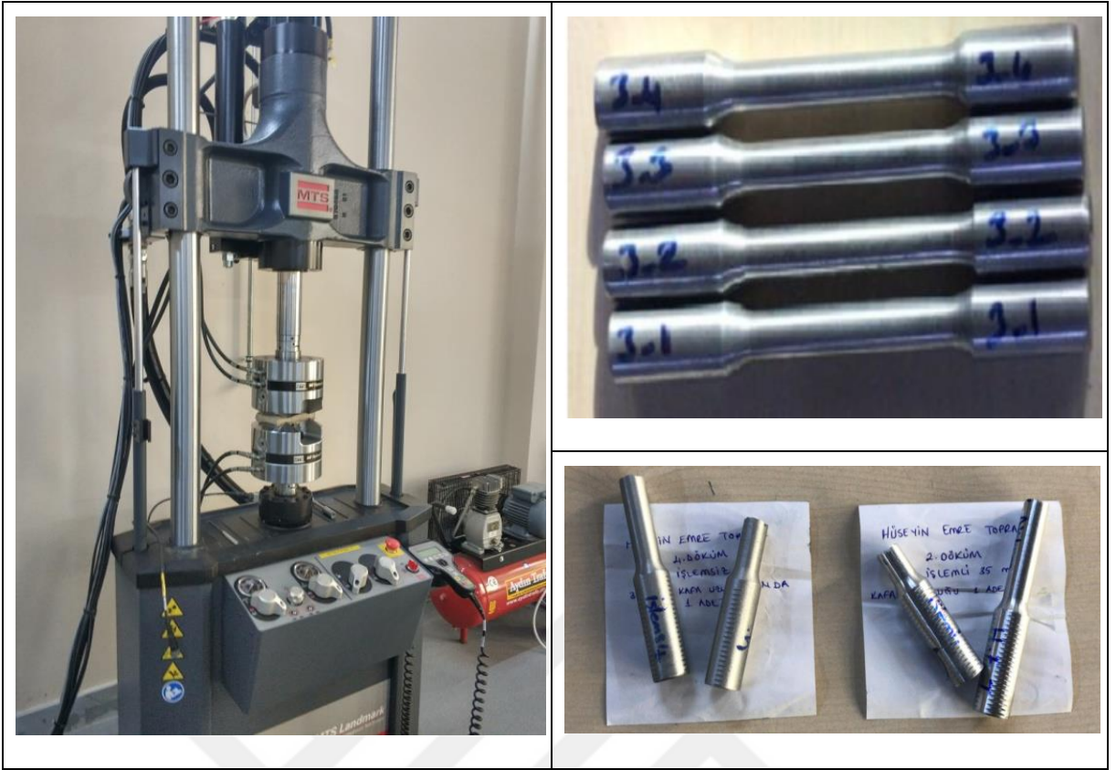
Şekil 16: Çekme Testi Cihazı, Test Numuneleri, Test Sonrası Numune Görüntüsü
