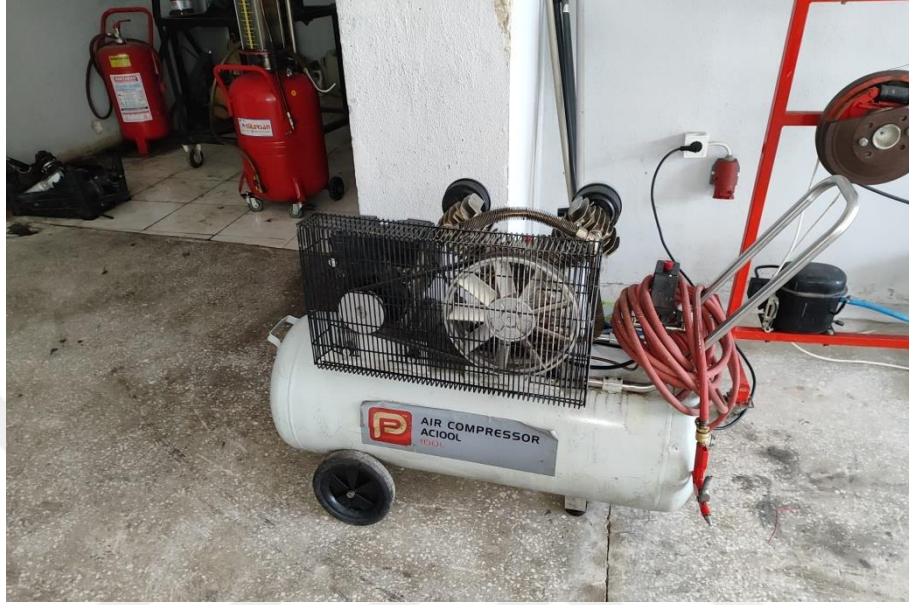
Şekil 4.14. Basınçlı Kabın Tecrit Edilmemesi
