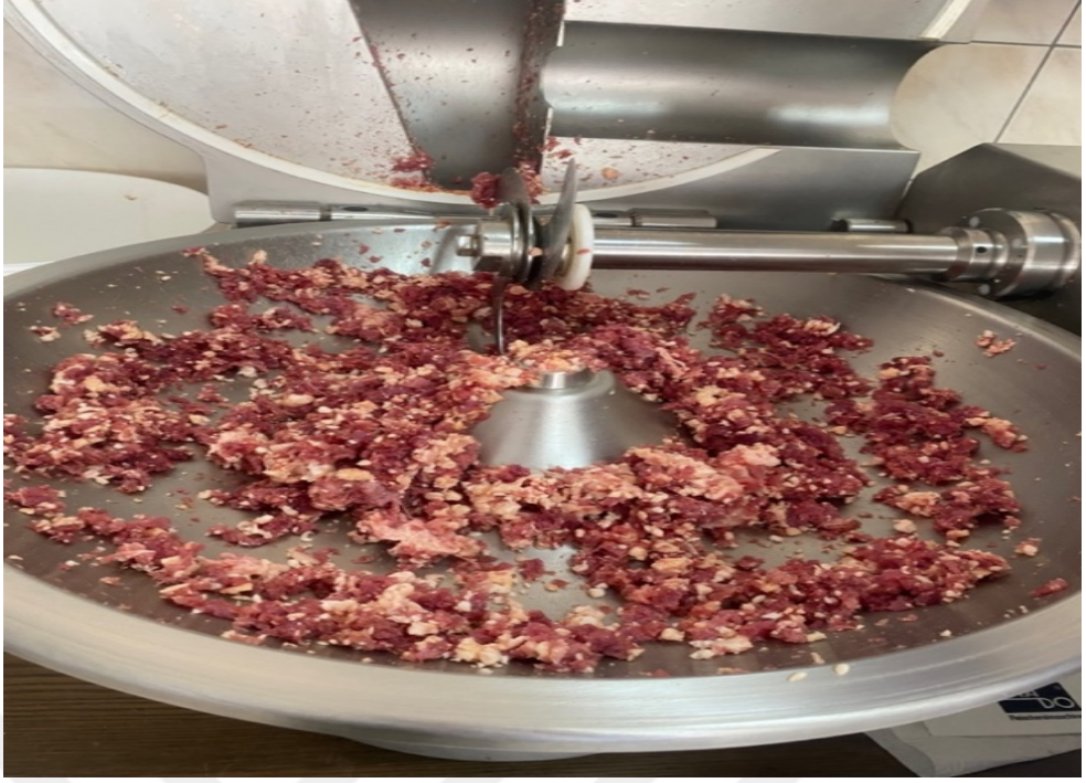
Şekil 1. Et ve yağların cutter makinesinde doğranması
