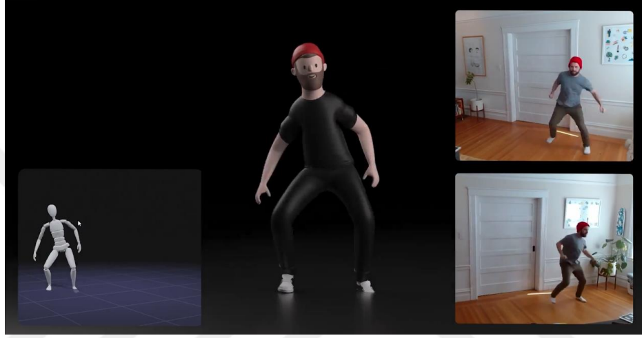
Resim 4.9. Çift Kameralı, İşaretçi Kullanılmadan Gerçekleştirilen Hareket Yakalama Örneği (Rokoko)
