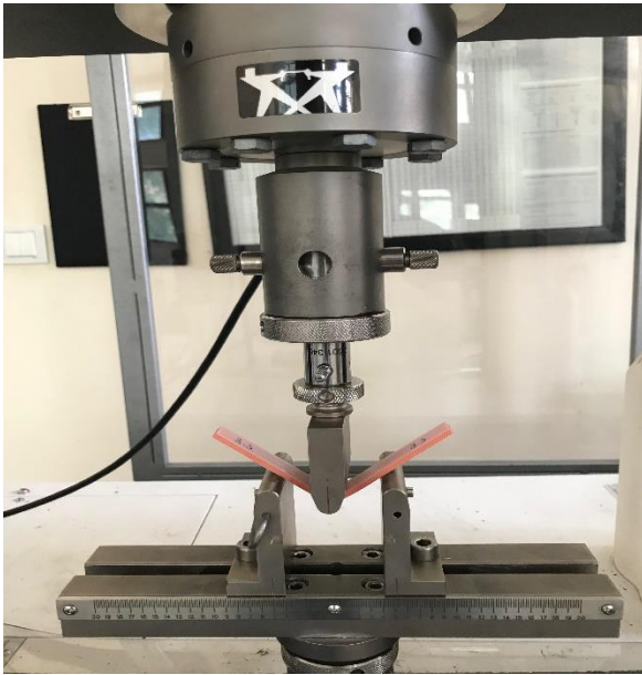
Şekil 6.1. 0,2 mm katman kalınlığındaki numunenin üç nokta eğme testi
