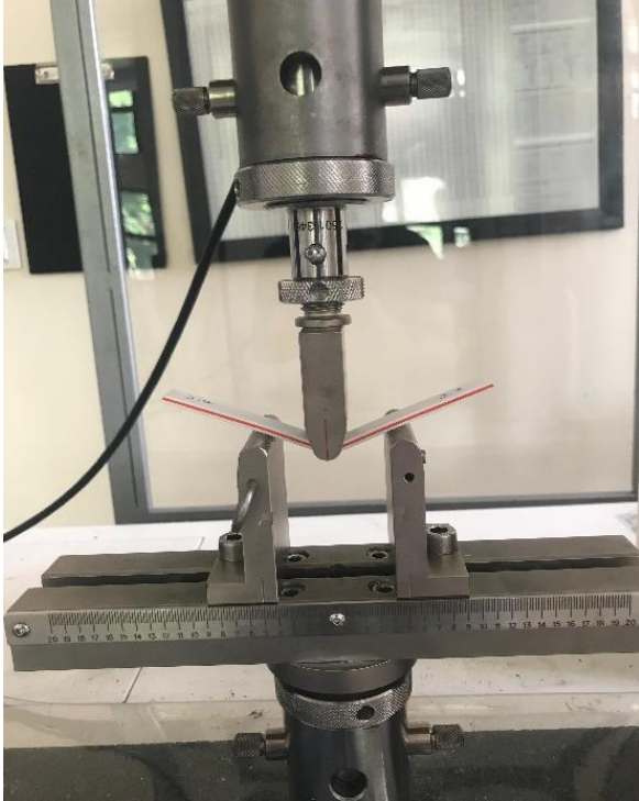
Şekil 6.3. 1 mm katman kalınlığındaki numunenin üç nokta eğme testi
