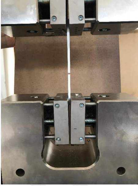
Şekil 6.8. Saf PLA numunesinin çekme testi sonrası görünümü
