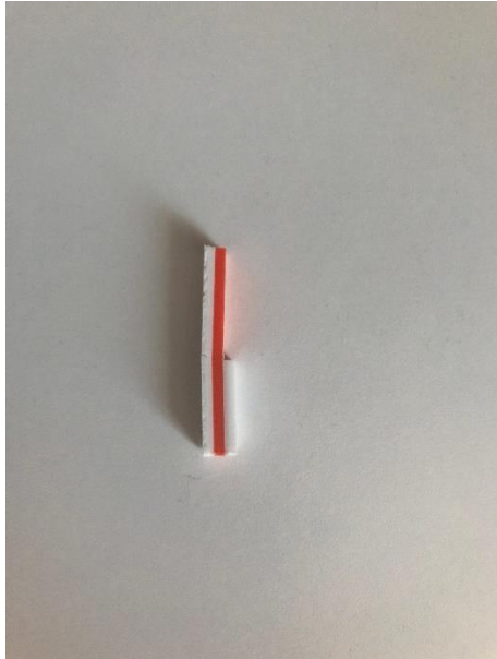
Şekil 6.13. 3 mm katman kalınlığındaki numunenin darbe testi sonrası görünümü
