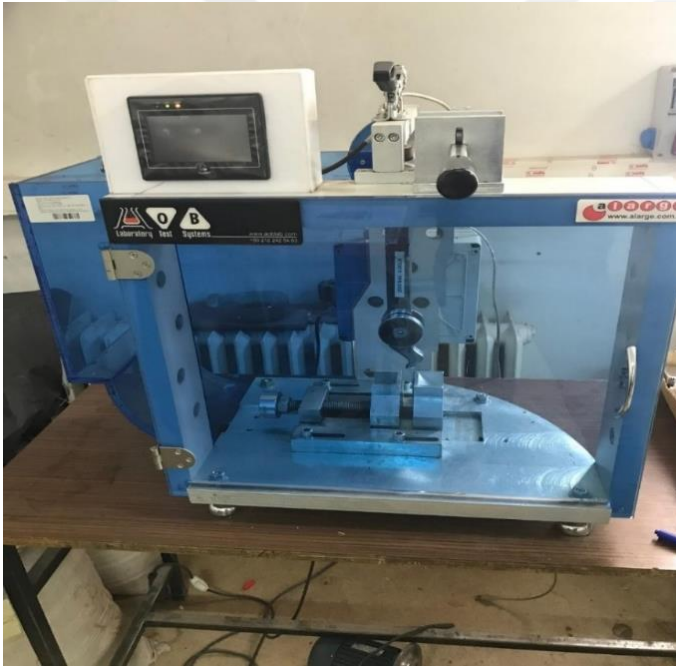
Şekil 5.10. Darbe testi cihazı
