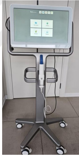
Şekil 3.3. Çalışma modellerinin dijital tarayıcı ile STL görüntülerinin oluşturulması
