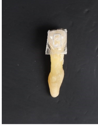
Şekil 3.4. Mine yüzeyinde pürüzlülük ölçüm alanlarının belirlendiği ataşman plak parçası
