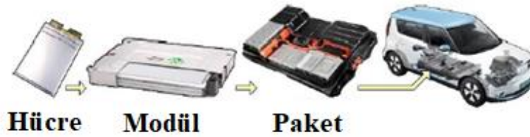
Şekil 4.2. Elektrikli araç bataryası üretim süreçleri [20]
