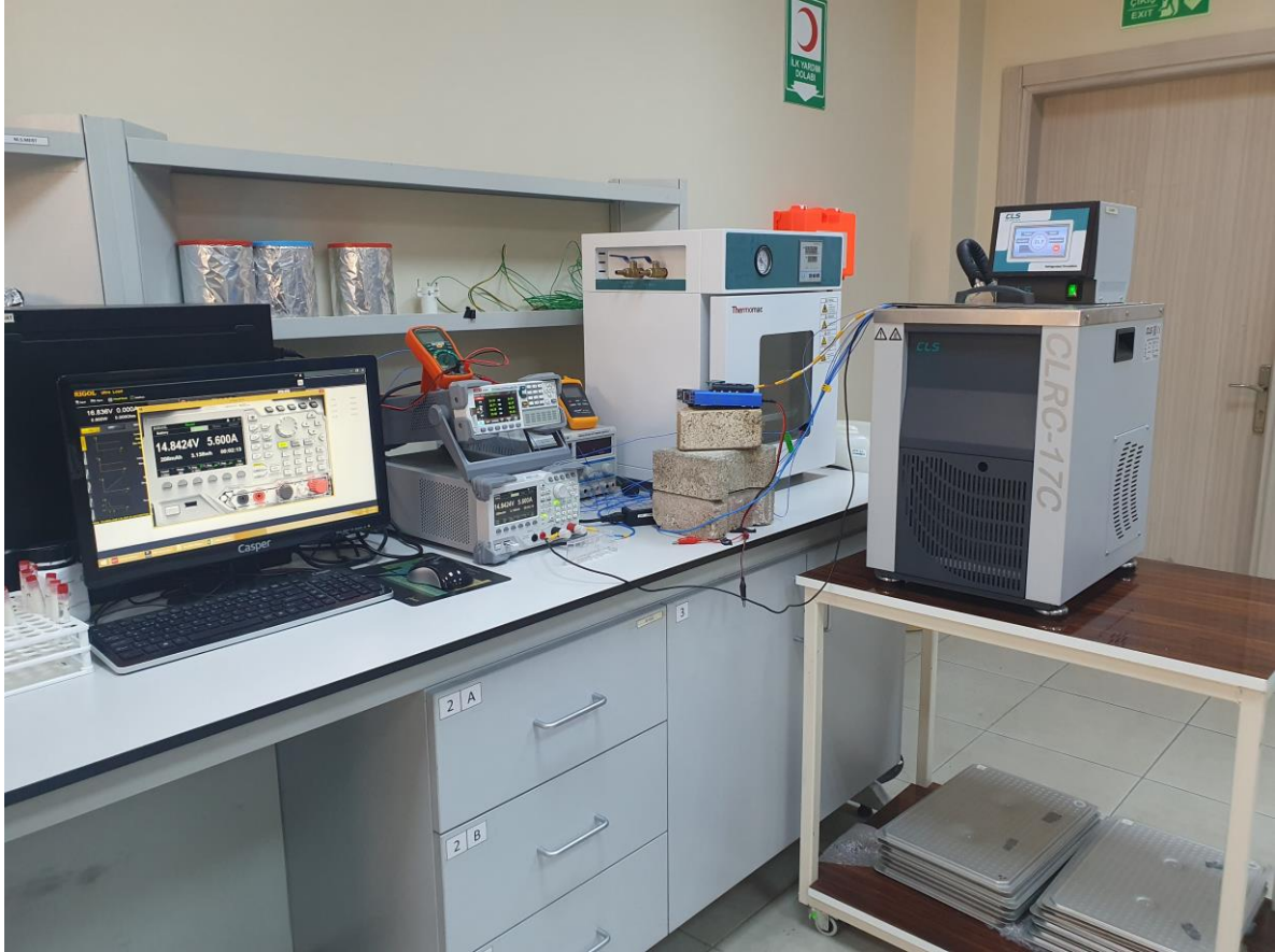
Şekil 7.1. Sentezlenen FDM’nin lityum hücreler üzerindeki etkisinin analizi için hazırlanan deney seti.
