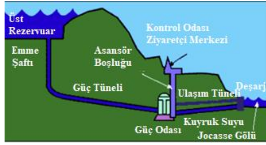
Şekil 3.3. Pompaj depolamalı hidroelektrik santrali şeması [11]
