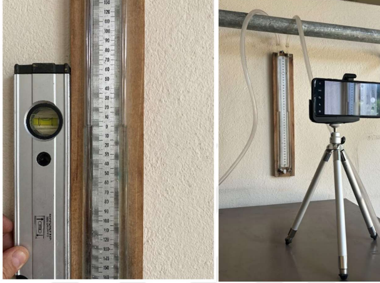
Şekil 3-6 U manometrenin su terazisi ile konumlandırılması ve basınç farkı ölçümünün kaydedilmesi
