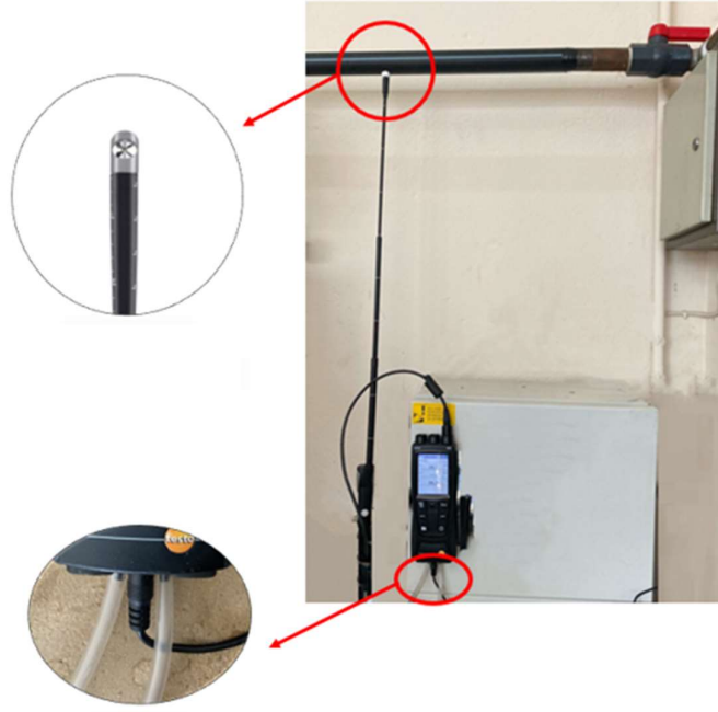
Şekil 3-9 Çok fonksiyonlu ölçer ile hava hızı ve basınç farkı ölçümü
