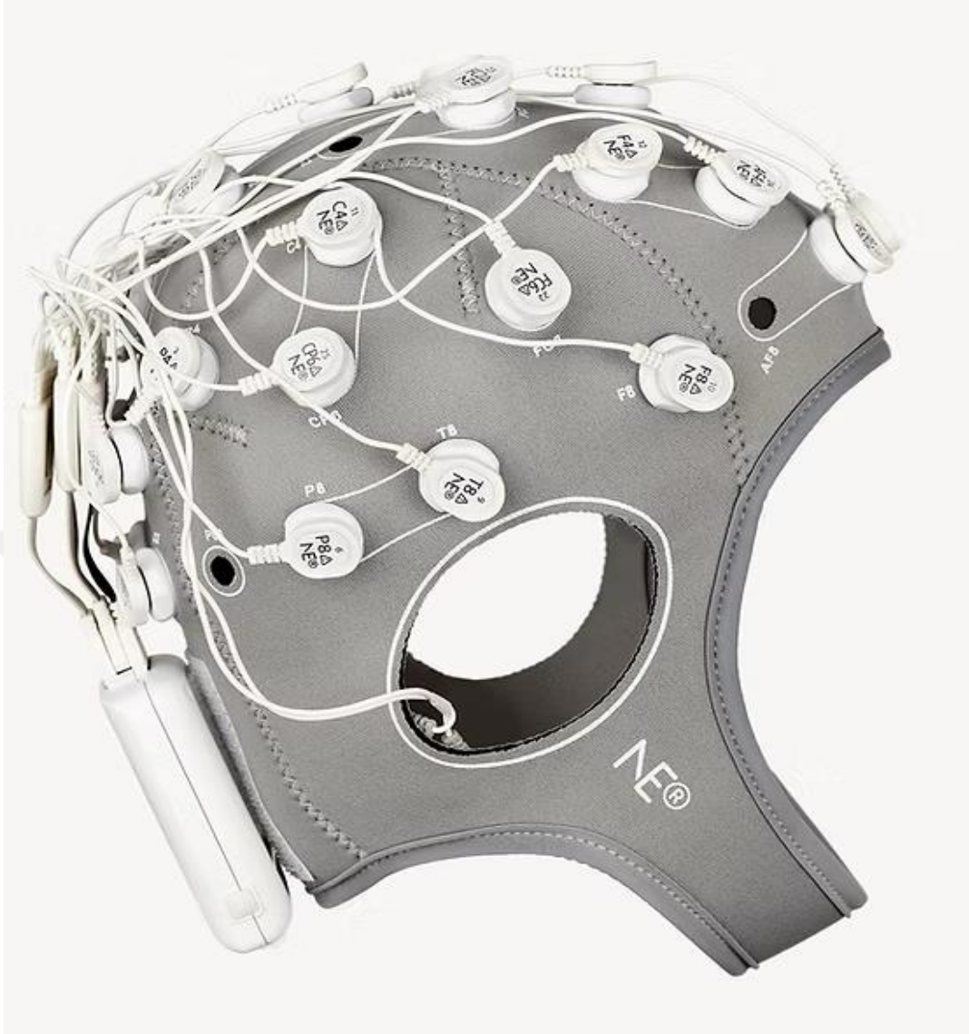
Şekil 2: Neuroelectrics Tarafından Geliştirilen Enobio 32 Model EEG Cihazı ( https://www.neuroelectrics.com/products/research/enobio/enobio-32 )
