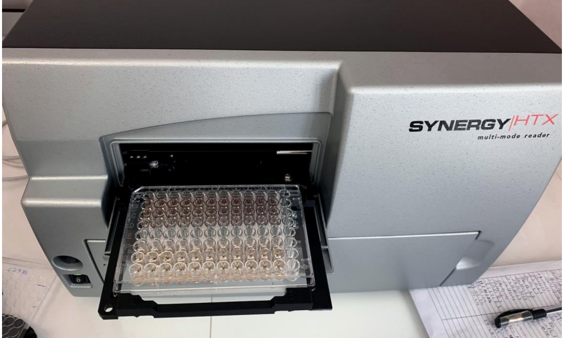
Şekil 9. MTT plağının mikropalak okuyucusuna yüklenmesi.
