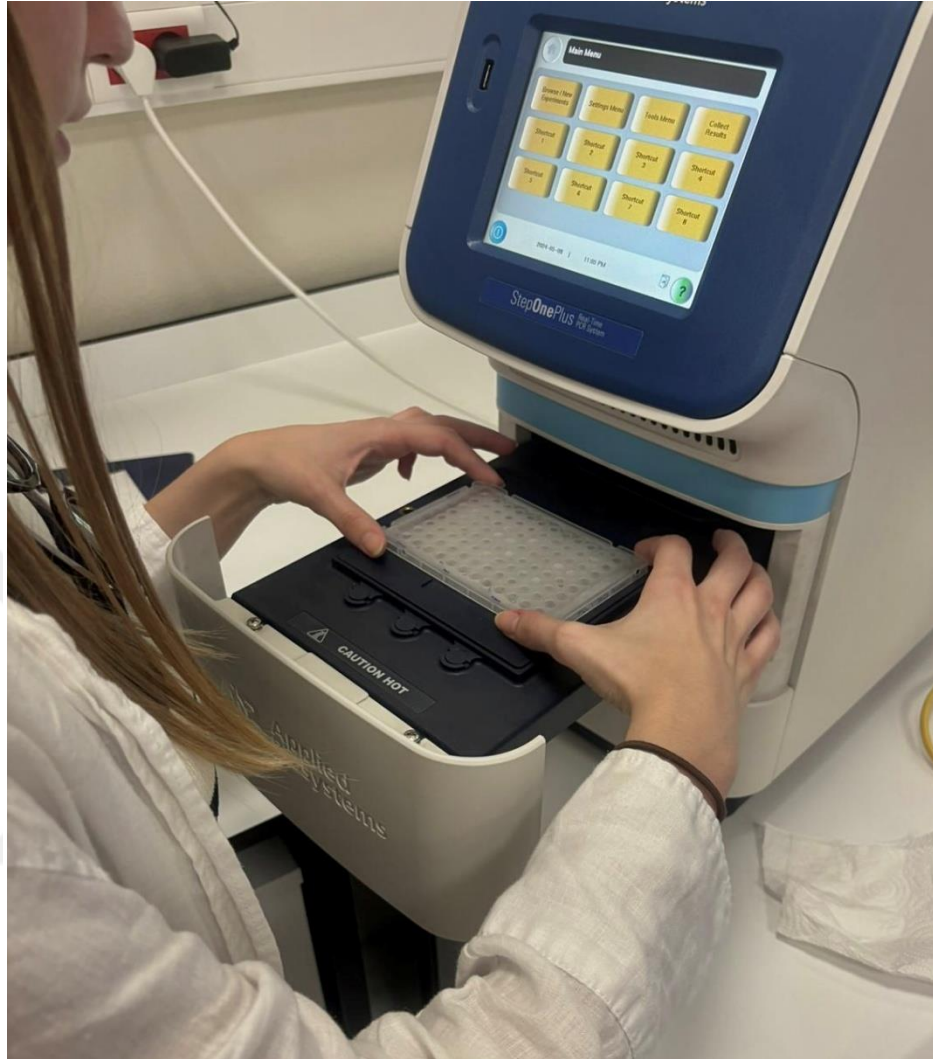
Şekil 17. Step One Plus Real-Time PCR System cihazına plakanın yerleştirilmesi.
