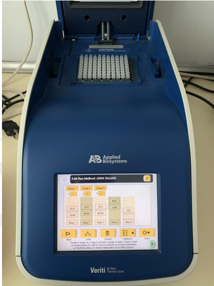
Şekil 15. Veriti 96 kuyucuklu Thermal Cycler cihazında cDNA sentezi.
