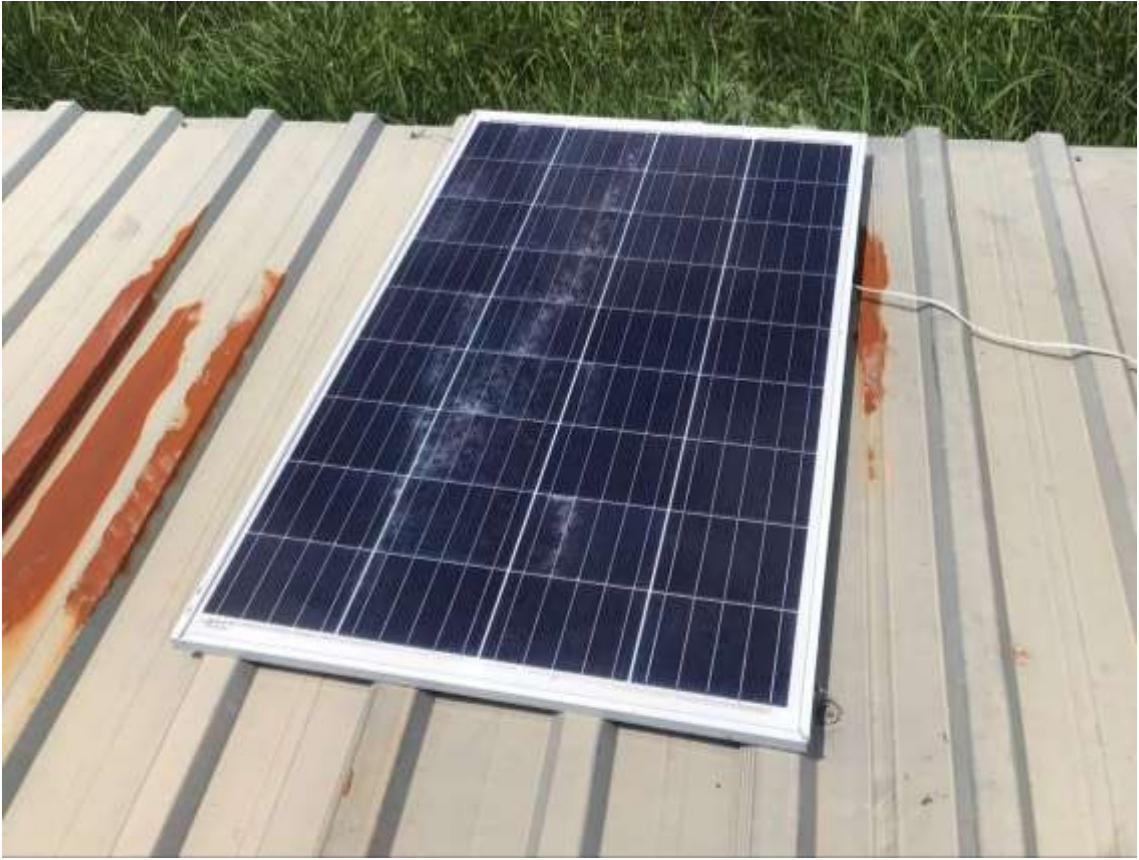
Resim 3.8. 12V, 130 W, 32 Hücreli Polikristal Yapılı Güneş Paneli
