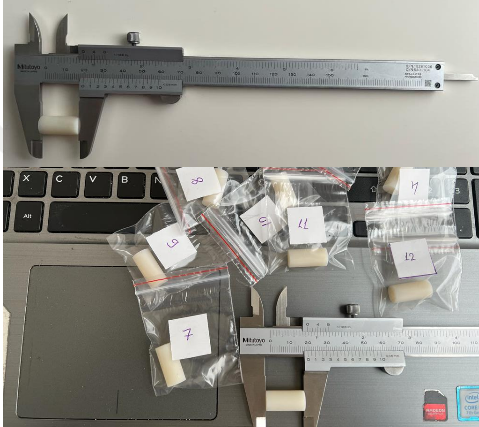
Şekil 27. Test numunesi boyut ölçümü
