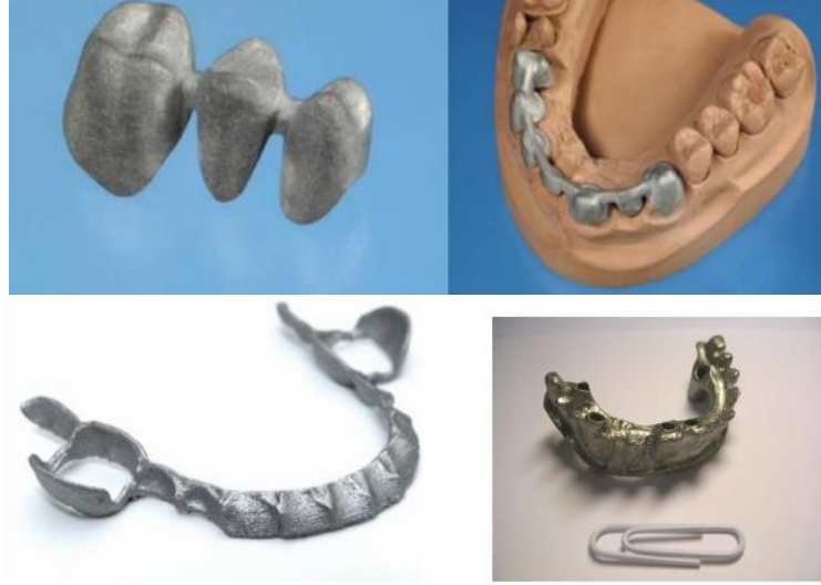
Şekil 14. CoCrMo ve Ti64 alaşımlarının dental alandaki uygulaması (Koç ve Yılmaz, 2016).
