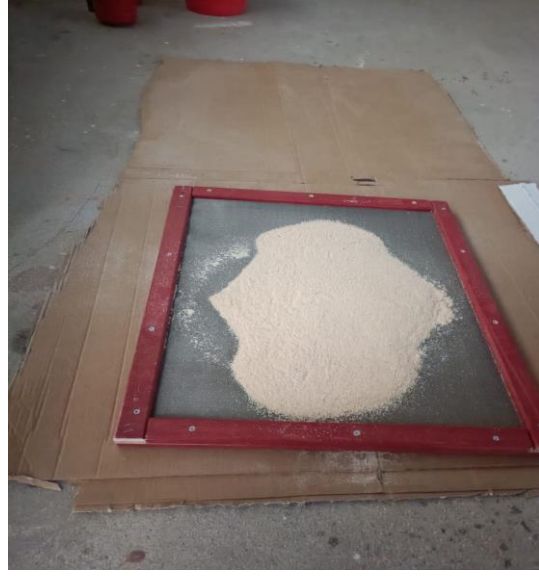
Şekil 3.5 Yonga pomza karışımının elenip karıştırılması
