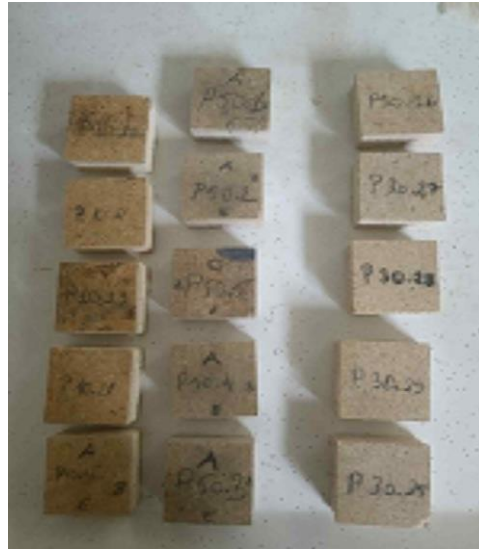
Şekil 3.9 5x5 mm Boyutundaki numunelerin hazırlanması
