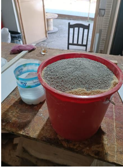
Şekil 3.5 Yonga pomza karışımının elenip karıştırılması
