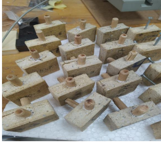
Şekil 3.14 Yüzeyden (a) ve kenardan (b) kavela tutma direnci deney numune örneği. ( l : 50mm, t : 18 mm, h: 50 mm, l p : 20 mm)
