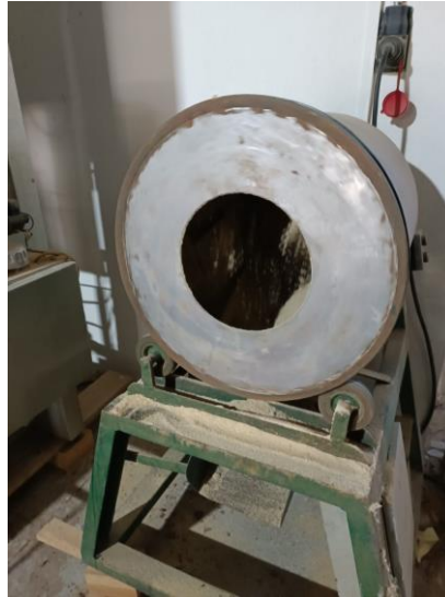
Şekil 3.6 Yonga, pomza ve tutkalın tamburda homojen olarak karıştırılması
