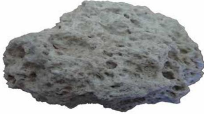
Şekil 2.4 Ponzanın ani ısınma ve soğuma sonrası bünyedeki gazların çekilip gözenekli bir yapı elde etme neticesi.
