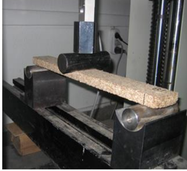
Şekil 3.11 Statik eğilme direnci deneyi yapılışı
