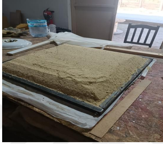
Şekil 3.7 Oluşturulan karışımın kalıba dökülüp preslenme aşamasına hazırlanması.
