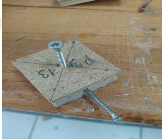
Şekil 3.13 Yüzeyden (a) ve kenardan (b) vida tutma direnci deney örneği ve hazırlanmış numune ( l : 50mm, t : 18 mm, h: 50 mm, l p : 15 mm)
