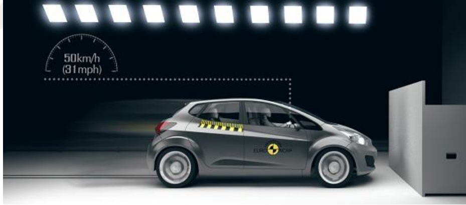
Şekil 2.15: Rijit Bariyere Tam Genişlikli Önden Çarpma Testi [20].
