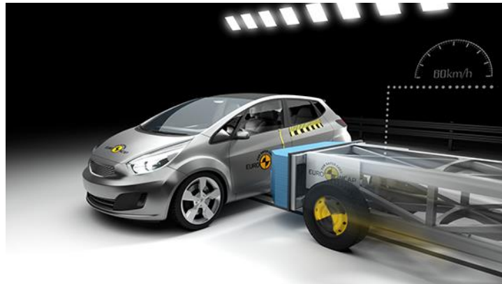
Şekil 2.17: Hareketli Deforme Olabilen Bariyere Yandan Çarpma Testi [22].
