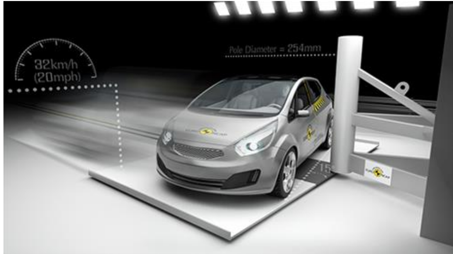
Şekil 2.18: Rijit Sütuna Yandan Eğimli Çarpma Testi [23].
