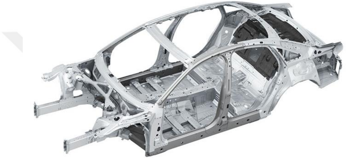
Şekil 2.6: Space Frame Tipi Otomobil Şasisi [17].
