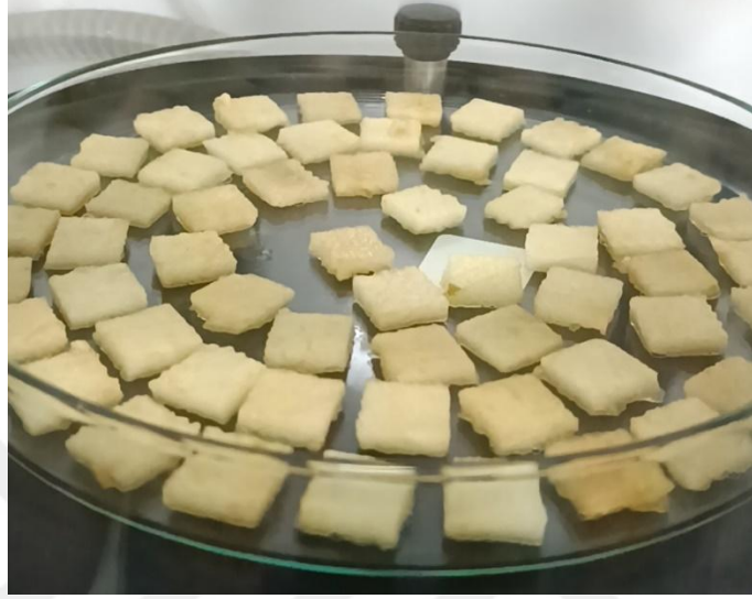
Şekil 3.12. Vakum ortamında işlem gören örneklerin -50^{\circ}\text{C} ile 0,010 mbar basınç altındaki görünümü
