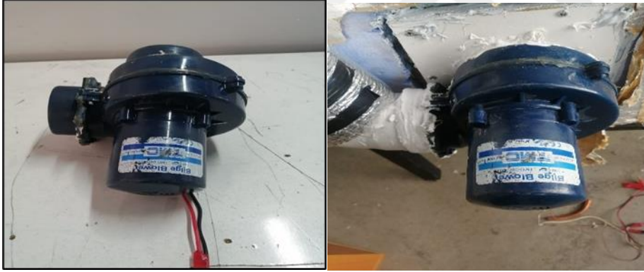
Şekil 5.8. Sistem hava fanı ve fırın-kanal bağlantısı.
