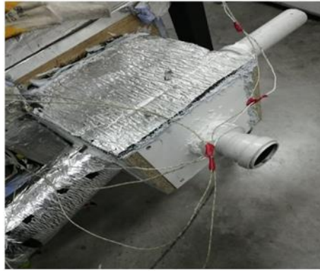
Şekil 5.7. Isı geri kazanım cihazı a) Cihaz şematığı, b) İmal edilen cihazın şekli.
