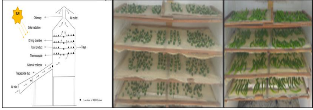
Şekil 2.9. Kurutma sistemin şematik gösterimi [15].
