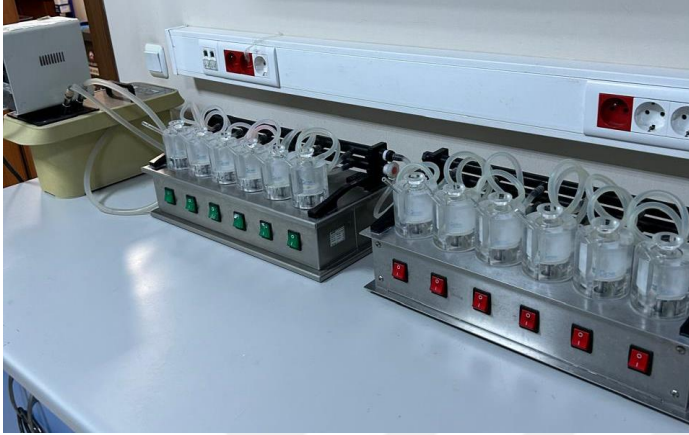
Şekil 3-4: Franz Difüzyon Hücreleri (PermeGear, ABD)
