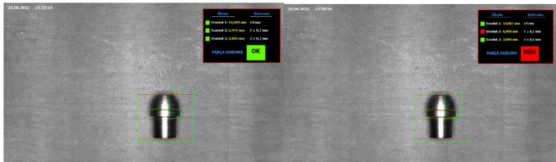
Şekil 5.2 : İkinci tip örnek parça hata tespiti.
