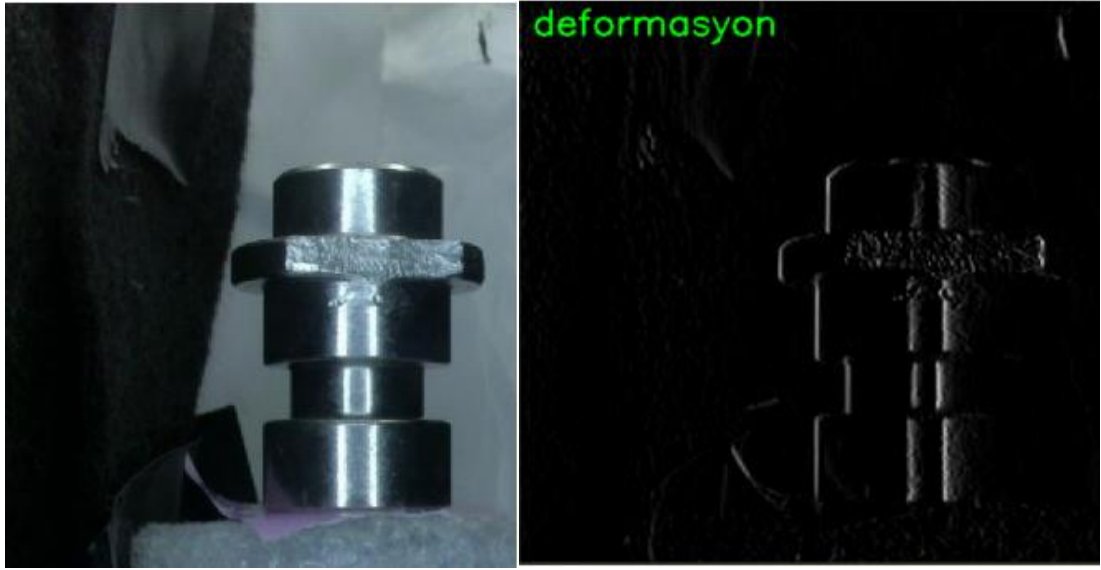
Şekil 5.11 : YSA metodu ile saptanan deformasyonlu parça.
