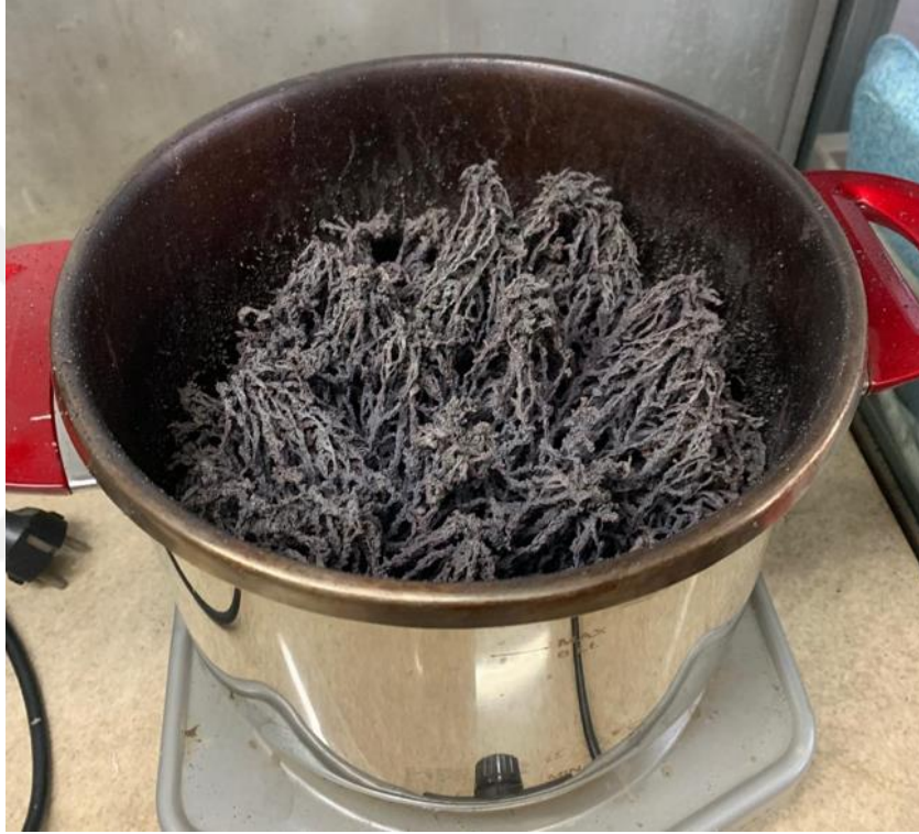
Şekil 6. Isı etkisi ile su ve jel yapıdan ayrıştırılan nikel ferrit nano parçacıklarının görünümü
