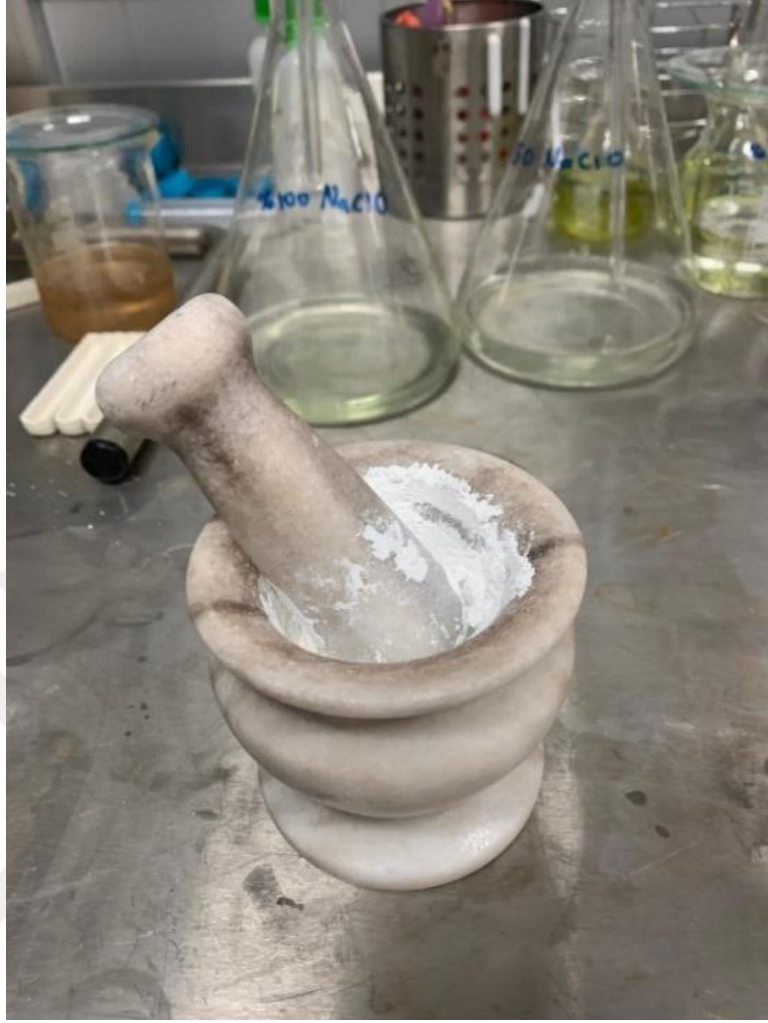
Şekil 5. Kalsinasyon işleminden sonra oluşan tozların havanda görünümü
