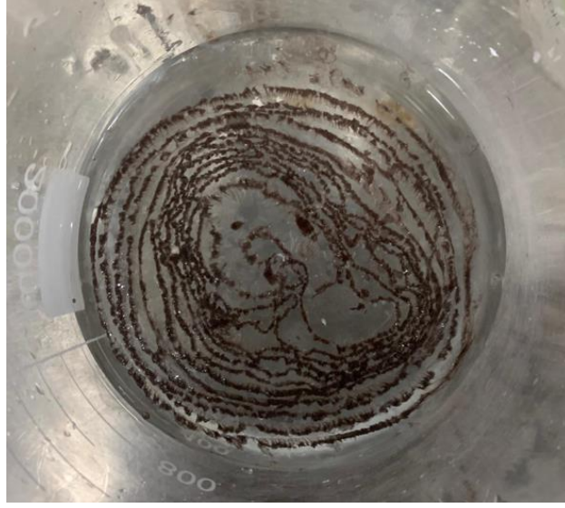
Şekil 7. Girdap oluşturulan saf suya enjekte edilen numunelerin oluşturduğu yapının örnek bir görünümü
