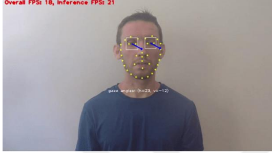
Şekil 2.3. Göz bakışı takibi için bilgisayarlı görme sistemi (Viso, 2024)
