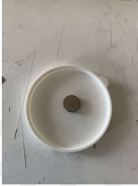
Şekil 3.5. Sinterlenip zımparalama ve parlatma işlemi uygulanmış numune
