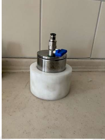
Şekil 3.1. Mekanik alaşımlarda kullanılan vakumlanabilir paslanmaz çelik hazne
