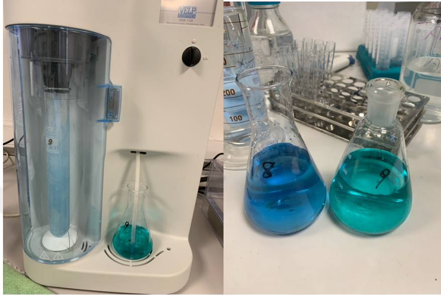
Şekil 4.2: Kjeldahl metodu protein tayininde distilasyon cihazı ve titrasyon öncesi ve sonrası renk değişimi gözlenen örnekler
