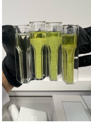
Şekil 4.4: Absorbansı 340 nm dalga boyunda ölçülen hidroliz derecesi belirleme analiz APH örnekleri
