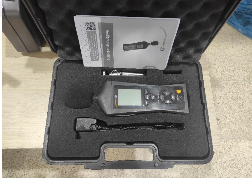
Şekil 4.13. PCE marka 322A ses seviye ölçme cihazı
