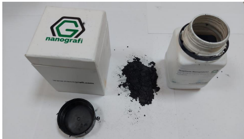
Şekil 4.9. 5 nm kalınlığında 7 µm çapında grafen
