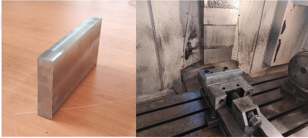
Şekil 4.1. 200x100x25 mm boyutlarında Hardox 500 çeliği plaka
