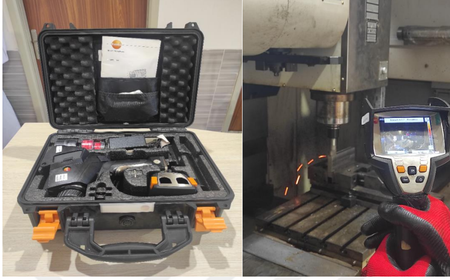
Şekil 4.14. Testo marka 881 model termal kamera ve ölçümü
