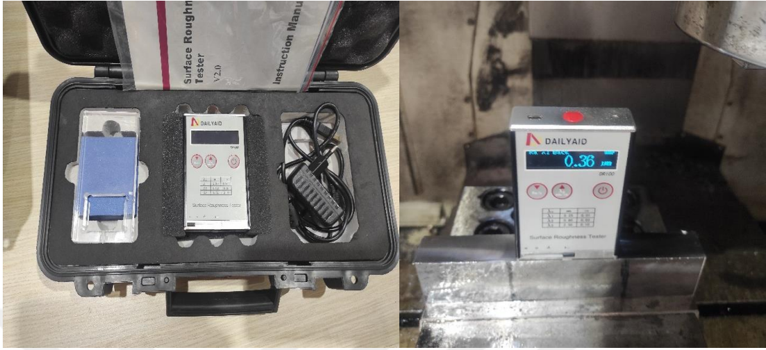
Şekil 4.11. Dailyaid marka DR100 model yüzey pürüzlülük cihazı ve ölçümü
