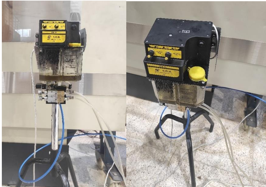
Şekil 4.6. Werte marka Mikro STN 15 model MMY yağlama cihazı
