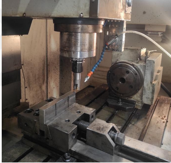
Şekil 4.7. Mikro yağlama cihazı lülesinin kesici takıma göre yerleştirilmesi
