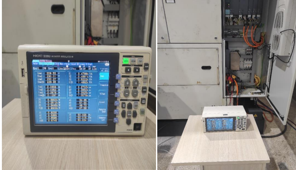
Şekil 4.15. HIOKI marka 3390 model güç analiz cihazı ve ölçümü
