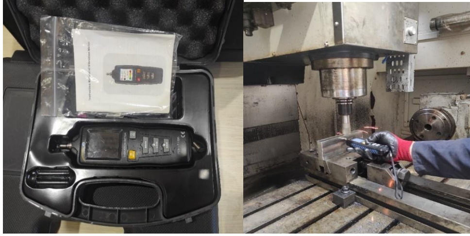
Şekil 4.12. PCE marka VT 1300 model titreşim ölçme cihazı ve ölçümü
