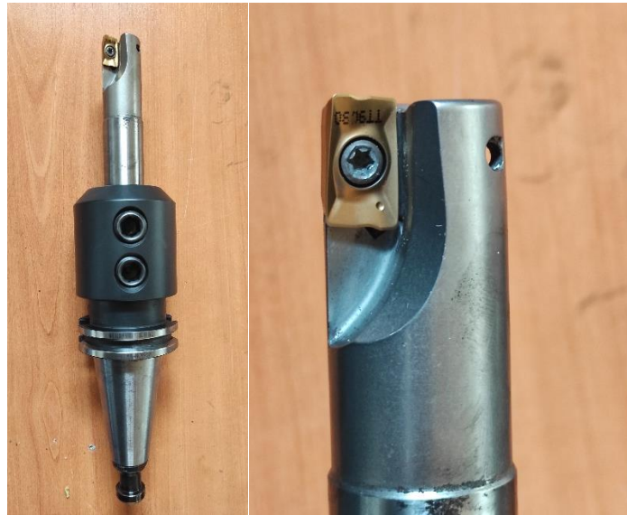
Şekil 4.5. Üç kesici takım bağlanabilen kesici takım tutucusu
