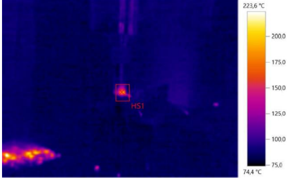
Şekil 5.13. Deney 9 koşulunda ısıdan etkilenen bölgenin sıcaklığı
