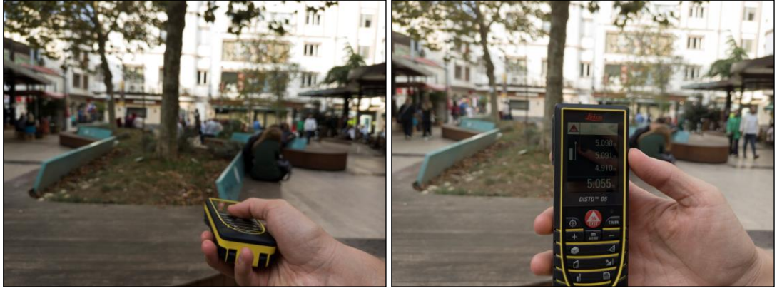
Şekil 3.20 Ağaçlara Olan Yatay Mesafenin Lazer Metre ile Ölçülmesi
