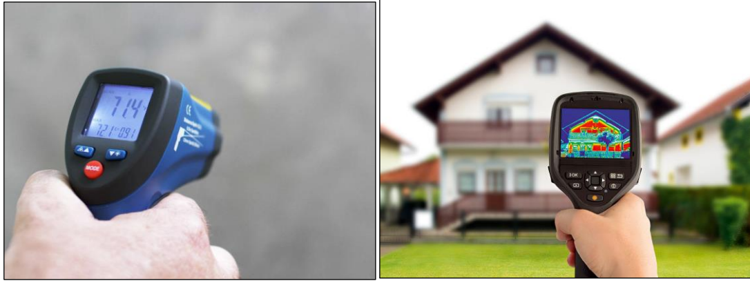
Şekil 2.7 Kızılötesi Termometre (Solda) ve Termal Kızılötesi Kamera (Sağda) (The New Economy, 2024; Tramex, 2024)
