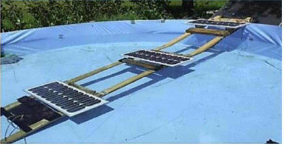
Şekil 24. Suyla daldırma ile soğutma (Özbaş & Alkış, 2018)
