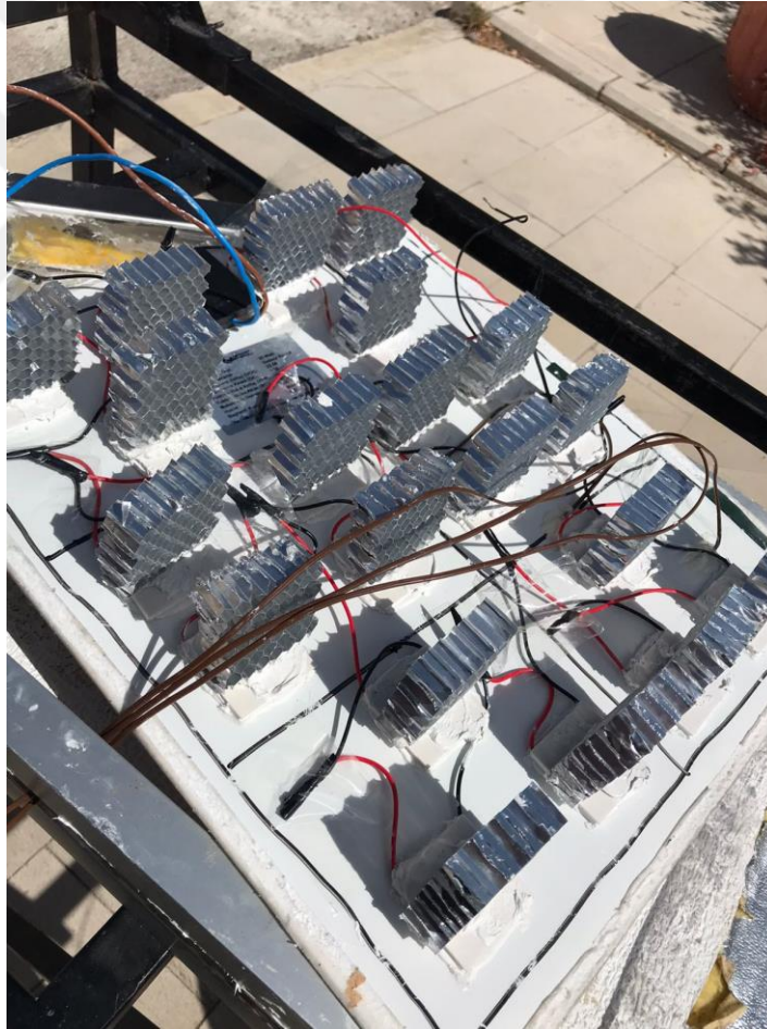
Şekil 65. 12705 serisi Peltier ve akış yönüne dik ( 90^\circ ) yerleştirilmiş alüminyum bal peteği kanatçıkları
