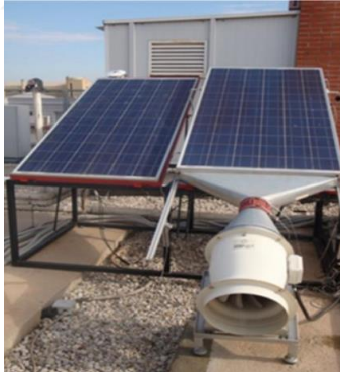
Şekil 25 Zorlanmış hava taşınımı ile aktif soğutma (Mazón-Hernández, García-Cascales, Vera-García, Káiser, & Zamora, 2013)
